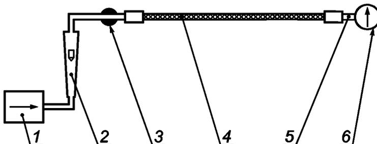
1 — регулируемый источник сжатого газа; 2 — ротаметр; 3 — кран; 4 — проверяемый шланг; 5 — переходник к манометру; 6 — манометр
