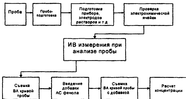
Рисунок 1. Измерения при анализе проб воды
