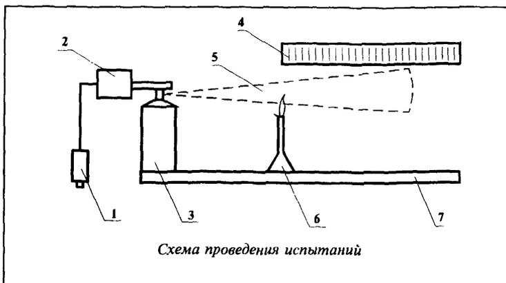
Перед проведением испытаний аэрозольную упаковку закрепляют в приспособлении (7) в таком положении, чтобы выходное отверстие клапана упаковки было на расстоянии  $(0,150 \pm 0,005)$  м от горелки, а ось аэрозольной струи была горизонтальна и направлена в верхнюю треть пламени горелки.
