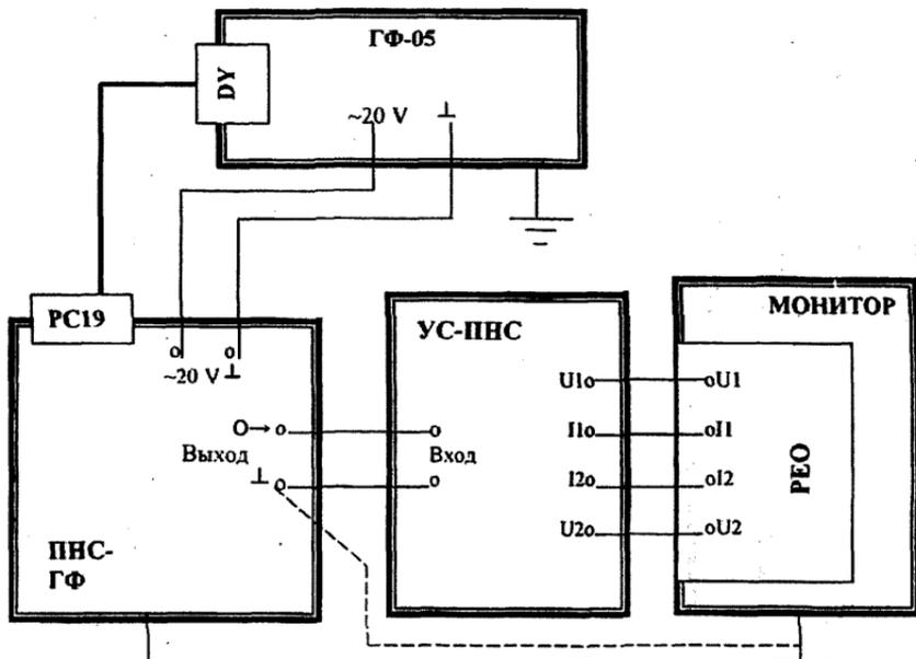
ГФ-05 – генератор функциональный; ПНС-ГФ – преобразователь «напряжение-сопротивление»; УС-ПНС – устройство согласования ПНС-ГФ.
