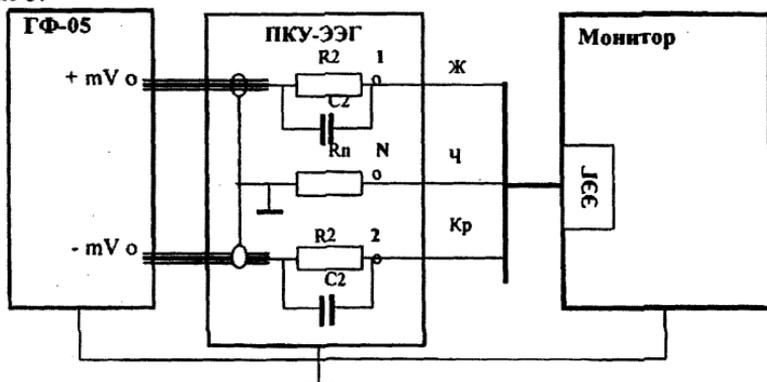
ГФ-05 – генератор функциональный; ПКУ-ЭЭГ – поверочное коммутационное устройство; 1, 2, N – гнезда ПКУ-ЭЭГ; Кр – красный электрод; Ж – желтый электрод; Ч – черный электрод
