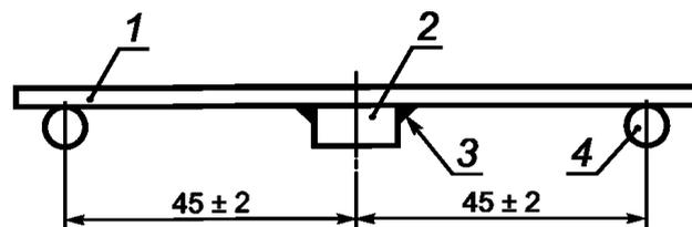
1 — стандартная разводка печатной платы; 2 — испытуемый образец; 3 — припой; 4 — опора
