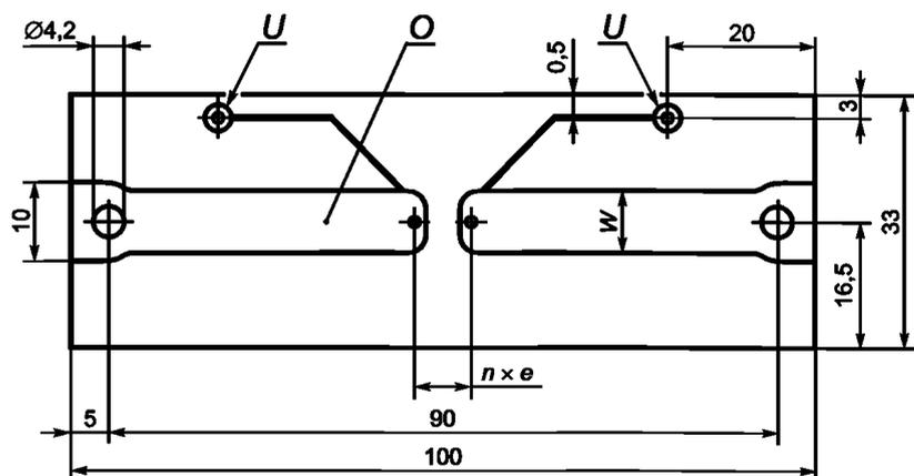
Рисунок 2 — Испытательная плата для плавких вставок для объемного монтажа
