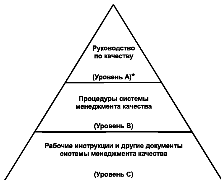
Рисунок 1 — Типовая структура документации системы менеджмента качества
