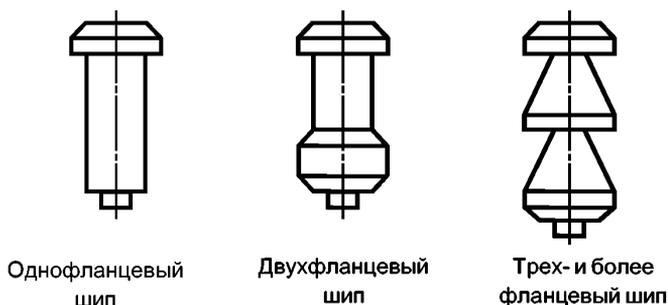
Рисунок 1 — Виды шипов по количеству фланцев
