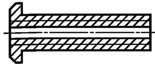
Рисунок Б.1 — Корпус шипа без износостойкого элемента
