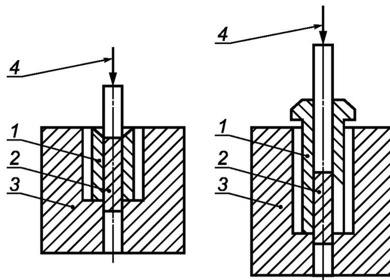
1 — корпус шипа; 2 — износостойкий элемент; 3 — подставка; 4 — направление выдавливания
