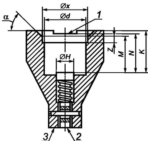
1 — поверхность X; 2 — поверхность W; 3 — поверхность V.
