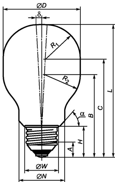
Рисунок Ф.2 — Наибольшие контуры ламп с цоколями E26/24 и колбой A55, PS55
