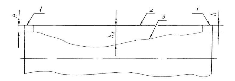
Рисунок Б 1 "Схема определения кривизны труб"
