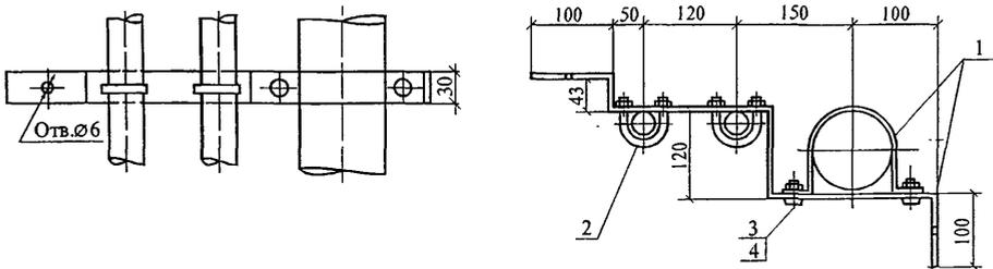
1 – полоса 4×38; 2 – хомут М6; 3 – гайка М6; 4 – болт М6×30
