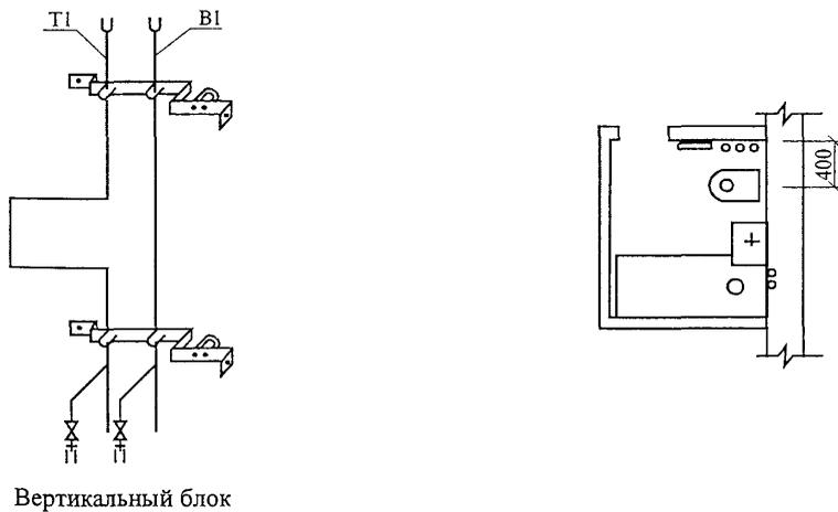
Рисунок 3 – Трубные блоки для монтажа в санузлах совмещенного типа
