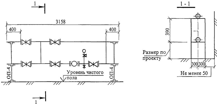
Рисунок 1 – Схема установки водомерного узла № 12
