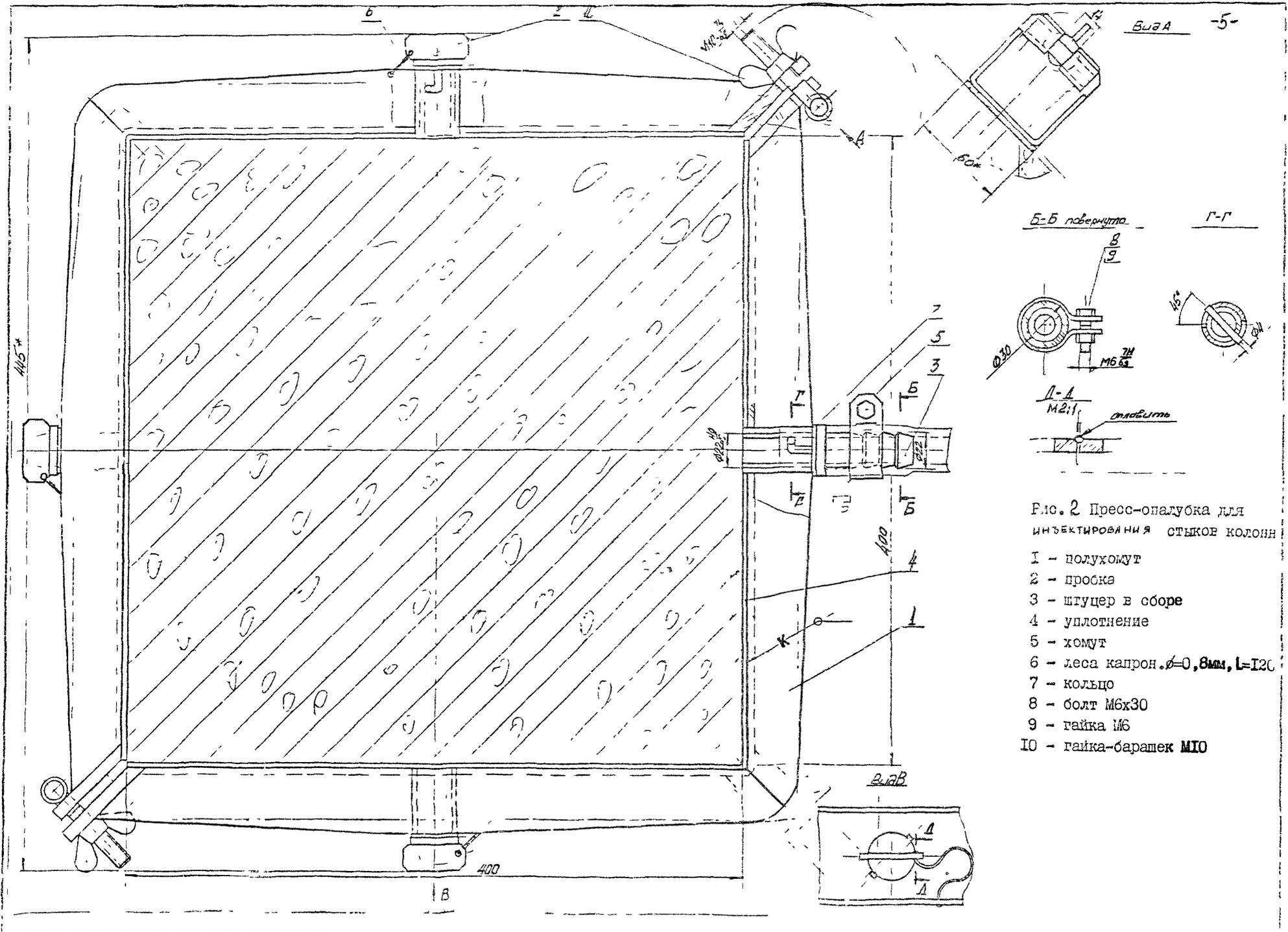
Рис. 2 Пресс-опалубка для инъектирования стыков колонн
