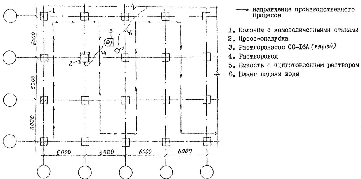
Рис. 4 Технологическая схема производства работ
