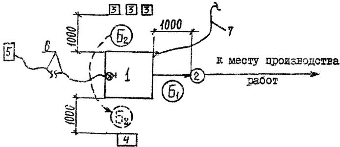
ⓑ<sub>1</sub> и ⓑ<sub>2</sub> - рабочие места бетонщиков;
