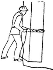
Бетонщик (Б<sub>1</sub>) соединяет штуцер раствора с одним из патрубков, оставляя остальные открытыми и дает команду бетонщику (Б<sub>2</sub>) о подаче раствора. При появлении потоков раствора из открытых патрубков бетонщик (Б<sub>1</sub>) закрывает их пробками.
