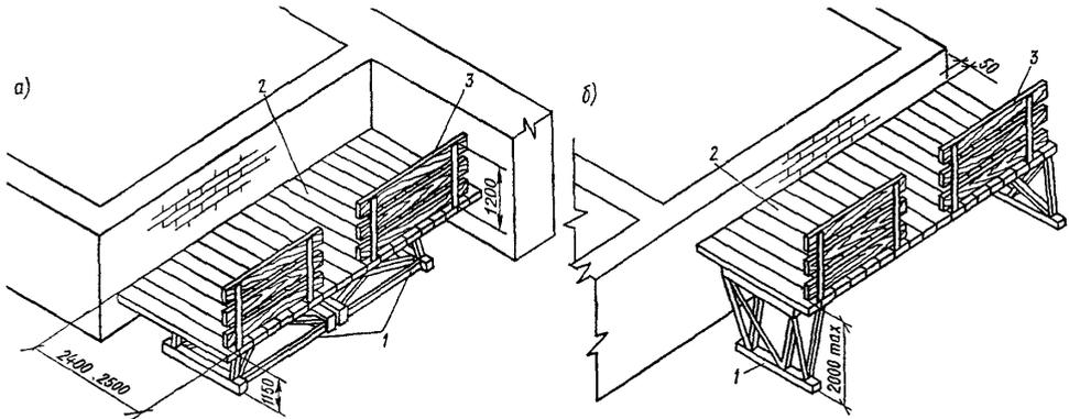
а – в нижнем положении (кладка второго яруса); б – в верхнем положении (кладка третьего яруса)
