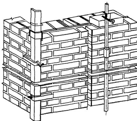
Рисунок 5 – Схема установки инвентарной металлической порядовки (шаблон)
