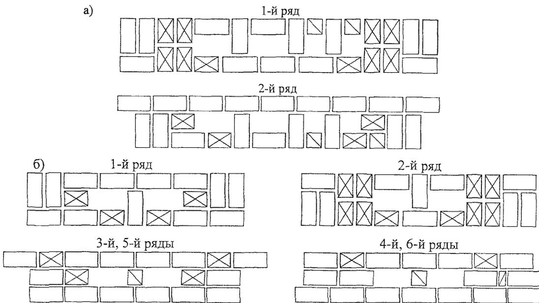
а) по однорядной системе перевязки в стенах толщиной в 1,5 кирпича
