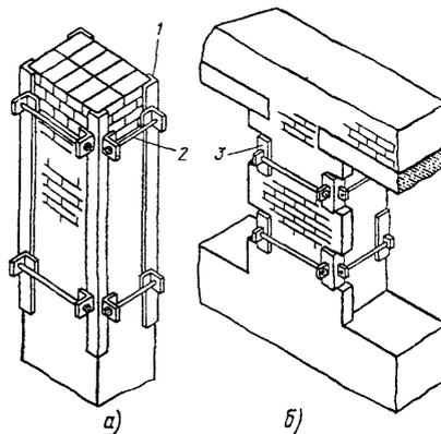
1 – стальной уголок; 2 – стяжной болт; 3 – хомуты со стяжными болтами
