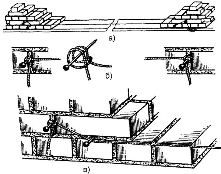
а – общий вид натянутой причалки, б – закрепление причалки двойной петлей, в – натягивание причалки
