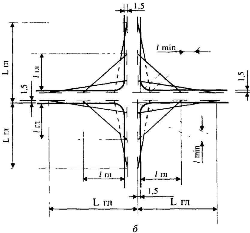
Рис. 4.1. Схемы определения видимости на пересечениях в одном уровне
