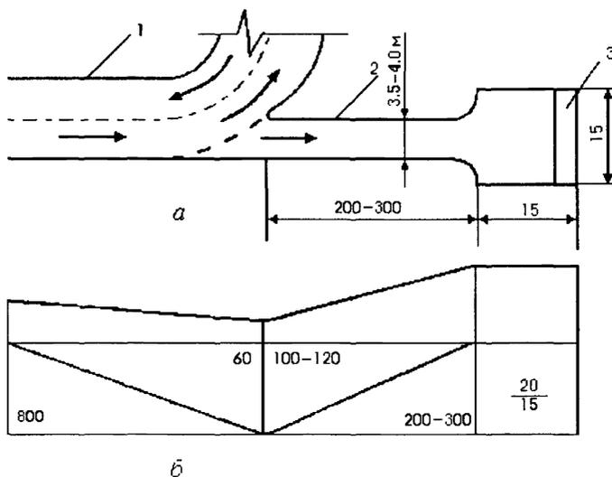
Рис. 1.3. Схема аварийного съезда
