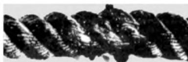
Рисунок С.12 — Химическое воздействие
