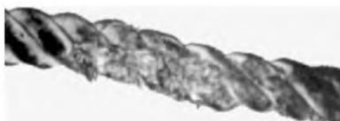
Рисунок С.11 — Механические повреждения
