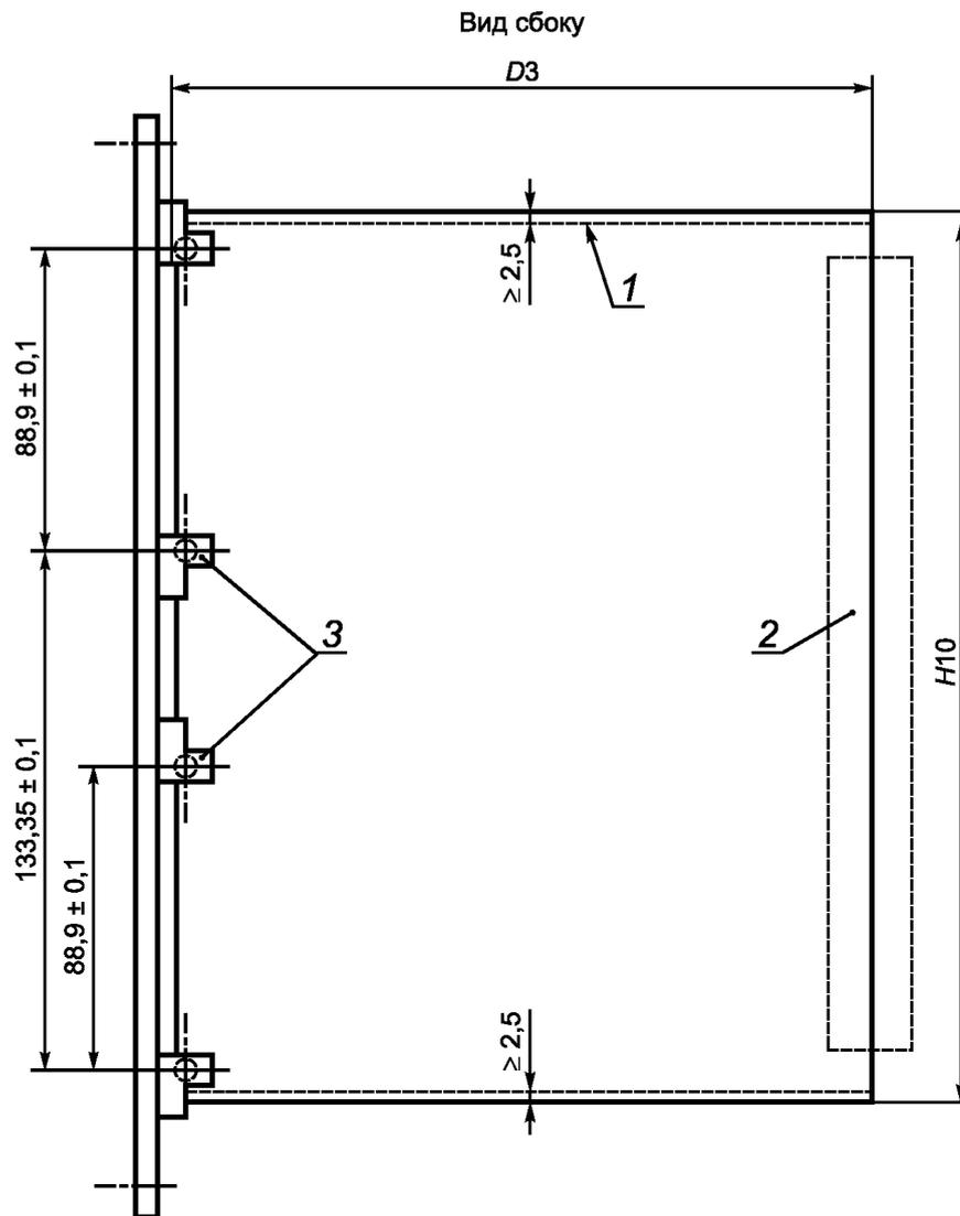
1 — зона для направляющей; 2 — зона соединителя; 3 — дополнительные фиксаторы
