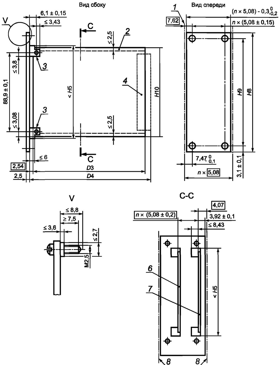
1 — линия шага выводов; 2 — зона для направляющей; 3 — резервная зона для крепления платы; 4 — зона соединителя; 5 — передняя сторона; 6 — положения последующих печатных плат; 7 — положение первой печатной платы; 8 — линия шага выводов
