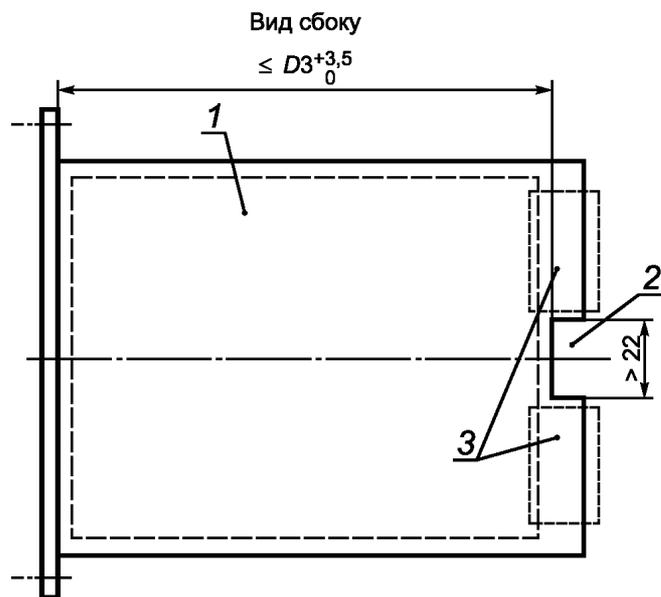
1 — печатная плата; 2 — вырез для промежуточной горизонтальной части блочного каркаса; 3 — зона соединителя
