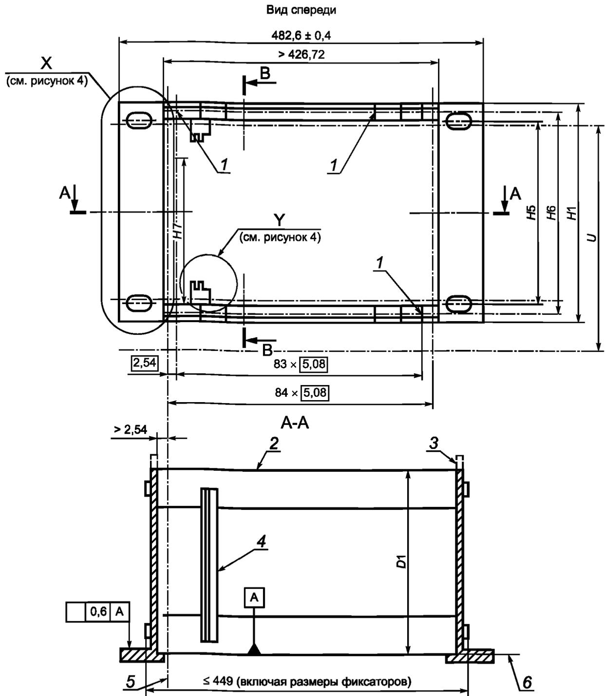
1 — монтажные отверстия спереди и сзади M2,5; 2 — задняя плоскость закрепления; 3 — боковая стенка может превышать размер  $D1$  (например с учетом защиты соединителей); 4 — типовая направляющая; 5 — первая линия шага выводов; 6 — передняя плоскость закрепления
