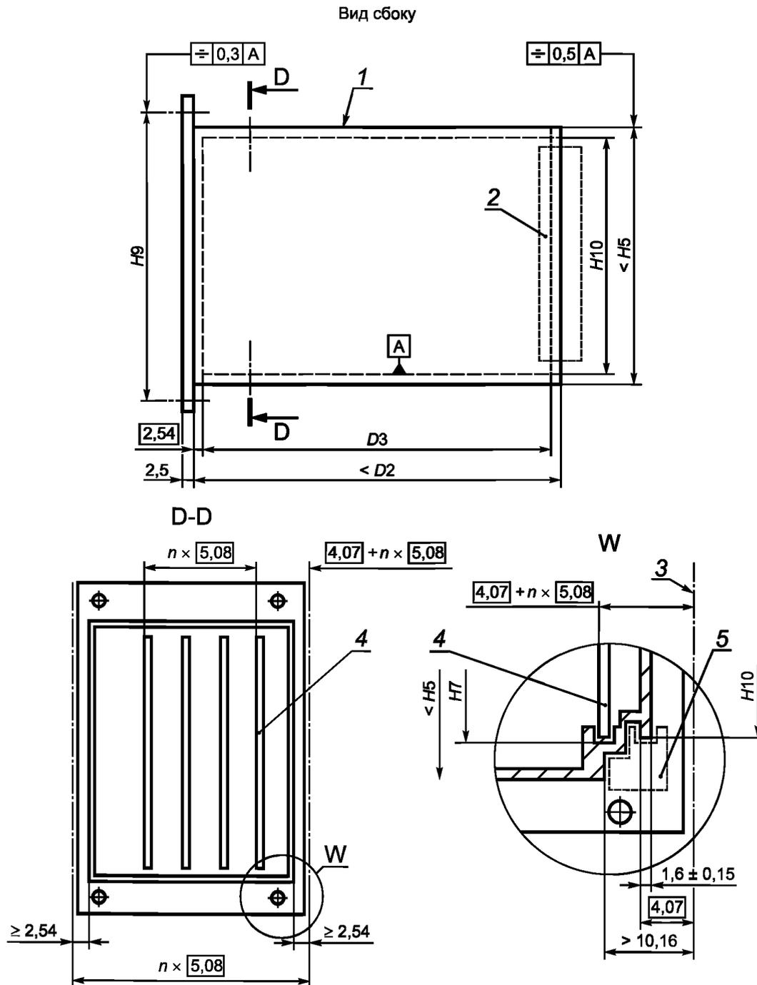
1 — печатная плата; 2 — зона соединителя; 3 — первая линия шага выводов; 4 — печатная плата; 5 — направляющая блочного каркаса
