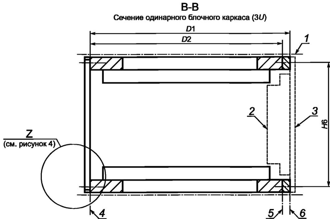
1 — разделяющая плоскость по высоте; 2 — соединитель; 3 — задняя панель; 4 — передняя плоскость закрепления; 5 — плоскость закрепления соединителей; 6 — задняя плоскость закрепления; 7 — разделяющая плоскость по высоте; 8 — дополнительный соединитель/кронштейн задней панели
