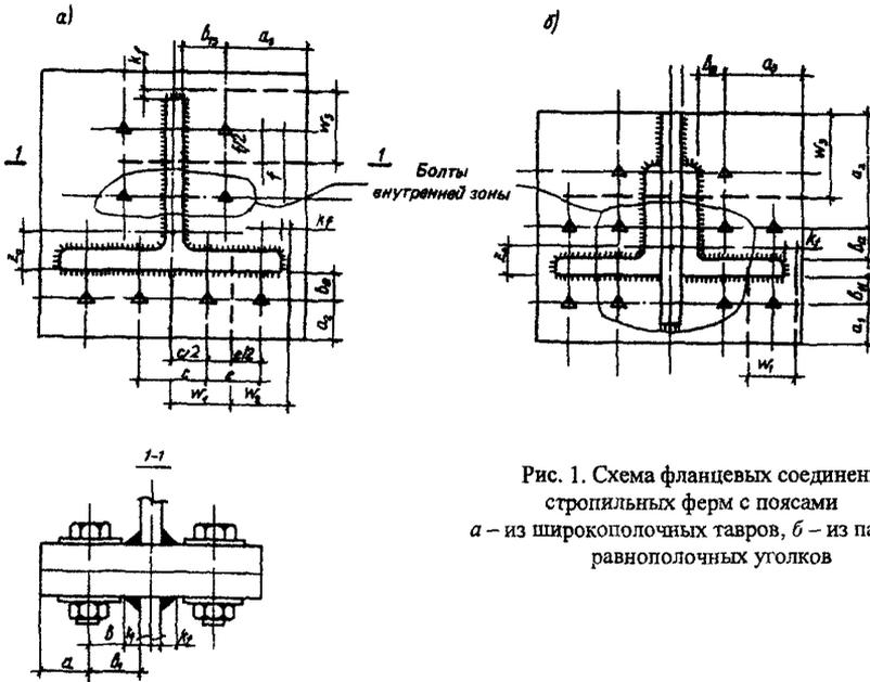
Рис. 1. Схема фланцевых соединений стропильных ферм с поясами
