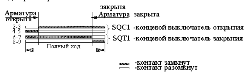
Рис. 1. Электрическая схема соединения концевых выключателей арматуры с ручным управлением
