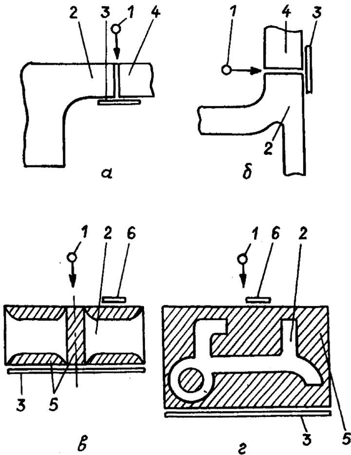
**Рис. П- 4.** Размещение приставок (заполнителей) - компенсаторов: 1 - источник излучения; 2 - контролируемый участок отливки; 3 - кассета; 4 - приставка-компенсатор; 5 - заполнитель-компенсатор; 6 - эталон чувствительности (а, б, в, г - см. табл. П-2)
