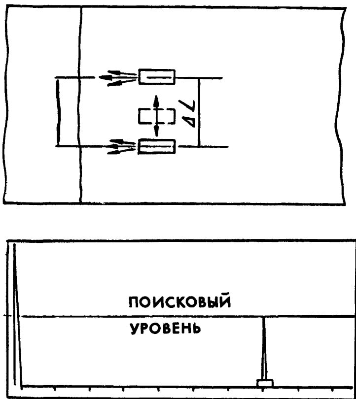
Рис. П14.7. Схема измерения условной протяженности дефекта
