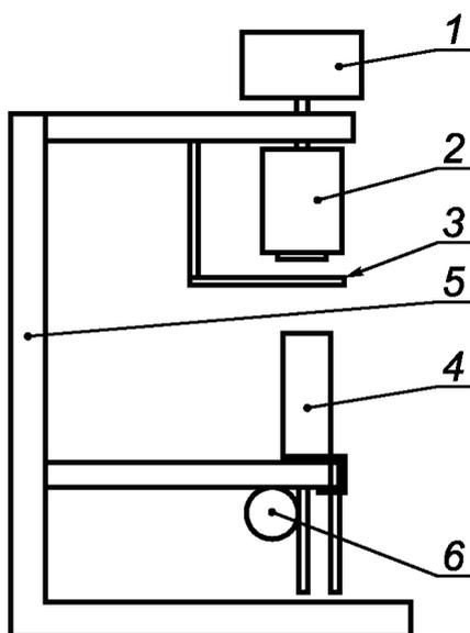
1 — дополнительный груз; 2 — нагревательный цилиндр с изоляцией; 3 — защитный экран; 4 — калориметр;
