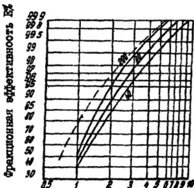
Диаметр частиц пыли  $d$ , мкм ( $\rho = 2,6 \text{ г/см}^3$ )Рис. 2.2 Зависимость фракционной эффективности  $E_f$  пылеуловителей типа ПЭМ от уровня воды
