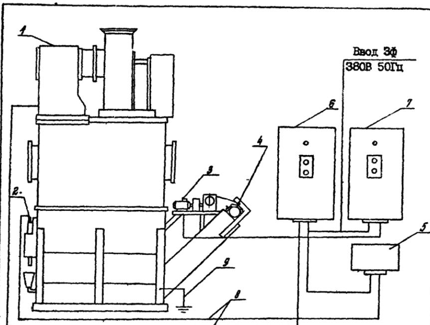
Рис.3. Электрооборудование пылеуловителя
