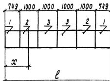
Расчетная схема поперечной балки
