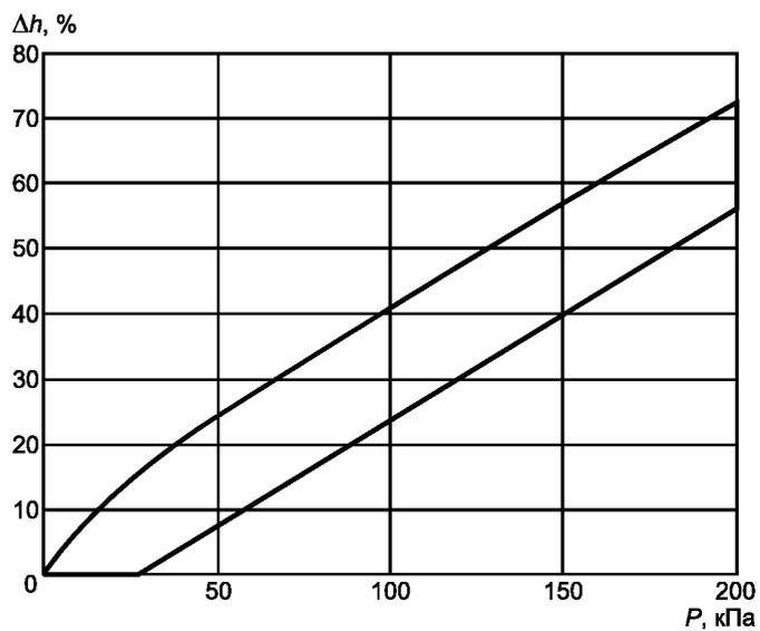
$\Delta h$  — относительное снижение толщины прокладки в результате передачи на нее давления  $P$
