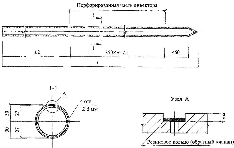
Рисунок 4.2 — Конструкция иньектора
