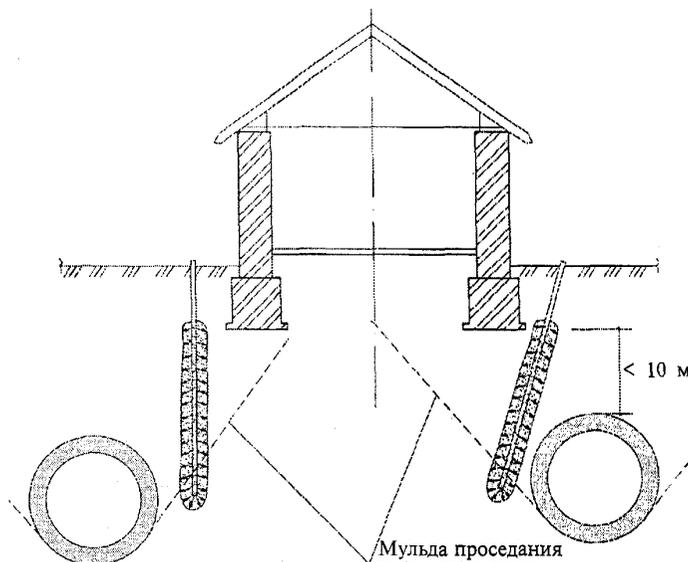
**Рисунок 1.3 — Защита фундамента здания при проходке тоннеля**
