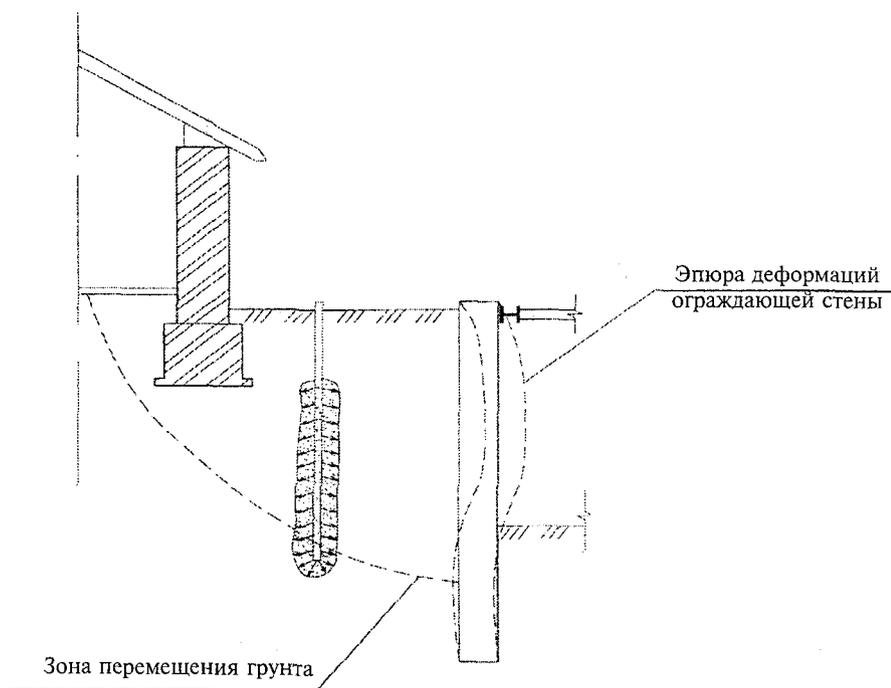
**Рисунок 1.1 — Защита фундамента здания при устройстве котлована**
