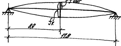
Схема замера прогиба при испытаниях
