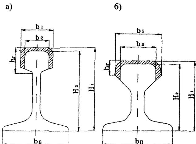
Рис. П.7.1. Поперечный профиль направляющих (а – типа Р; б – типа КР).
