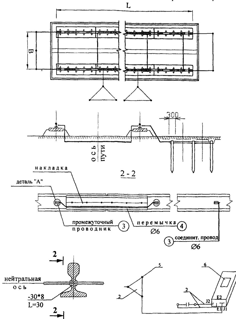
**Рис. П.8.5.** Заземление наземного кранового пути:
