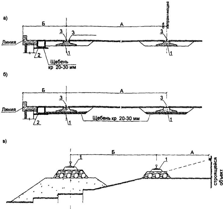
**Рис. П. 6.6.** Поперечный профиль наземных крановых путей.
