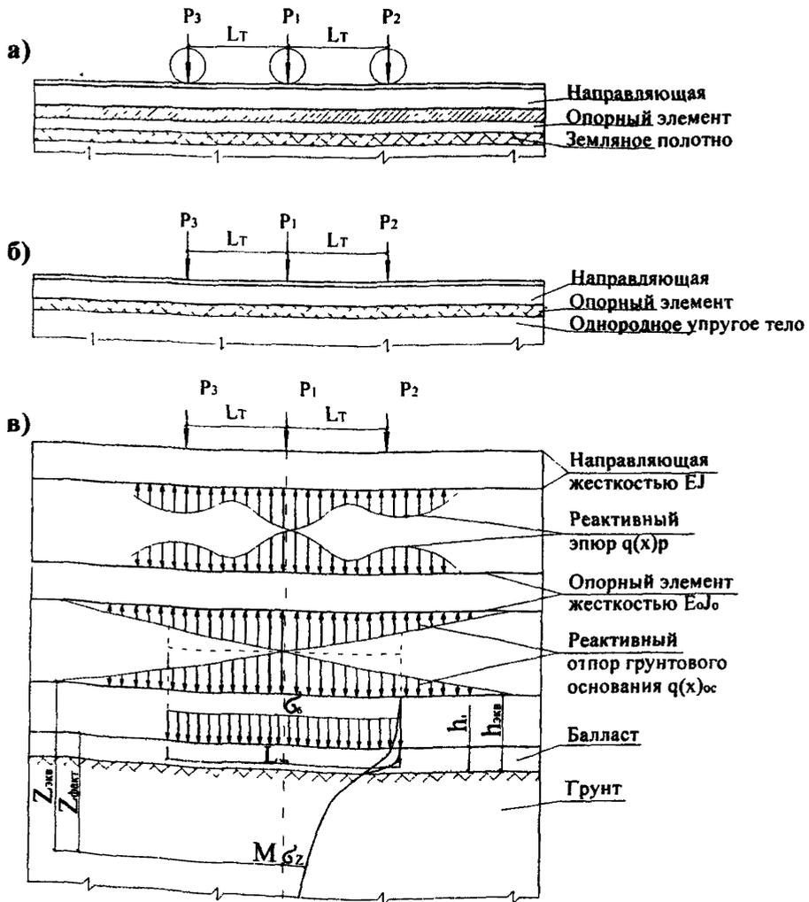
Рис II. 5.1. Расчетная схема наземного кранового пути
