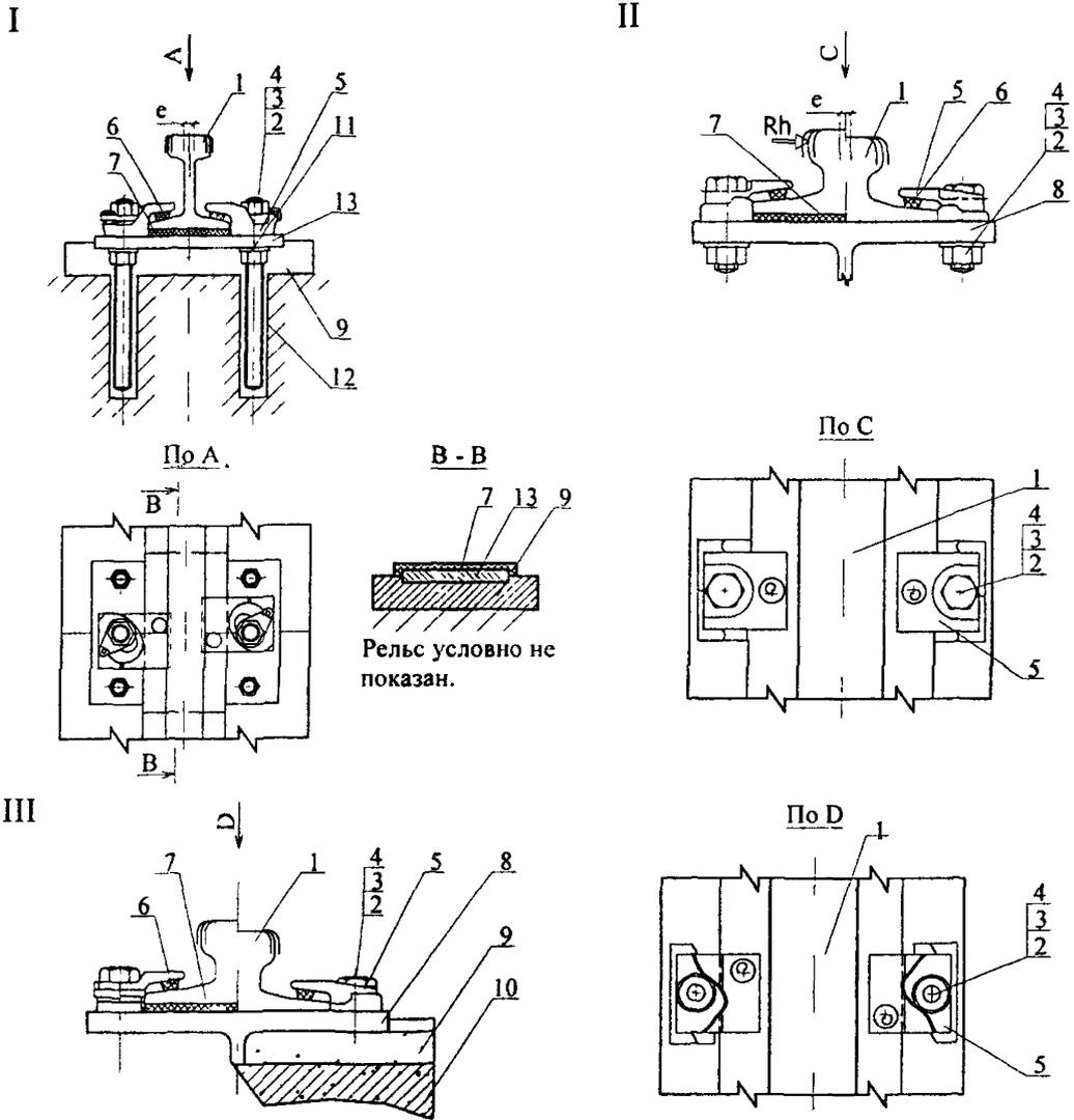
**Рис.П.5.11. Промежуточные скрепления с эластичным элементом (типа GANTREX):**
