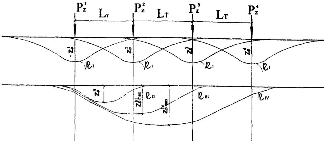
Рис.П. 5. 2.1 Прогибы рельсов под воздействием двух-, трех-, и четырехколесных тележек.
