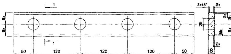
Рис. П.7.5. Накладка специальная для направляющих типа КР.
