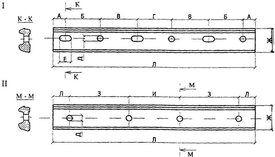
Рис. П.7.3. Стыковые двухголовые накладки для направляющих типа Р.
