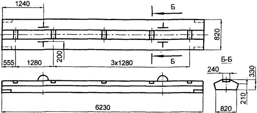
Рис. П.7.8. Железобетонная балка БРП - 62 8 3.
