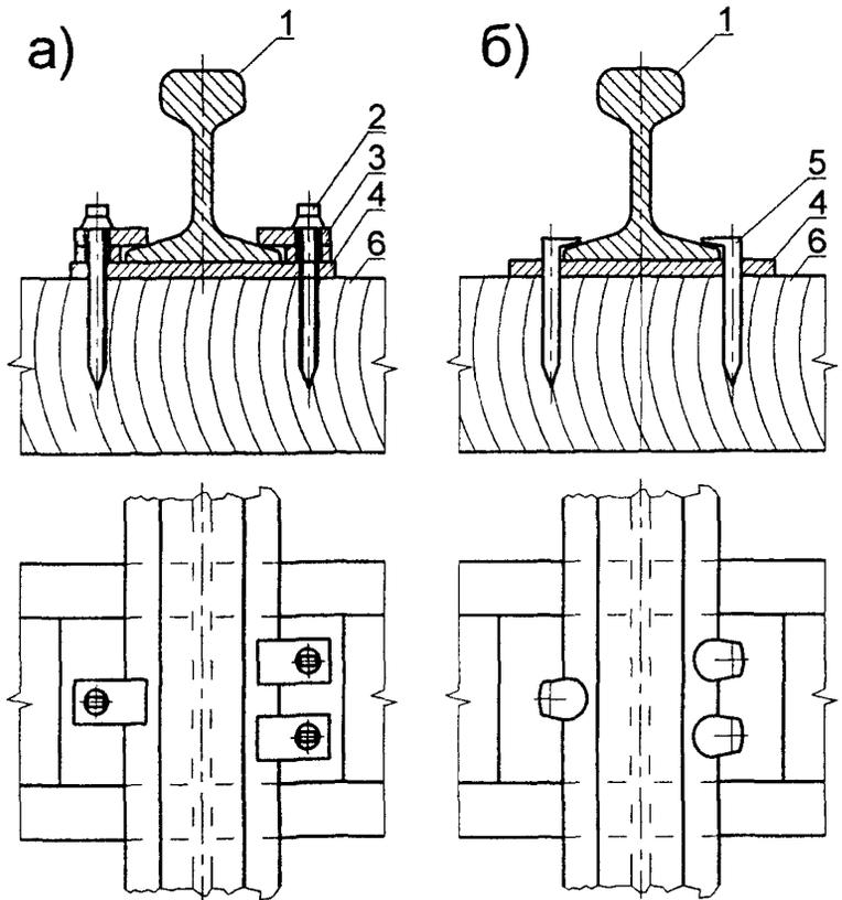
**Рис. П.7.13.** Прикрепление направляющих к полушалам:
