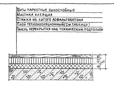
Показатель теплоусвоения поверхности пола  $\rm J_n$ =7,8 Bt/(m². °C) Конструкцию пола допускается применять только при производстве работ в зимнее время
