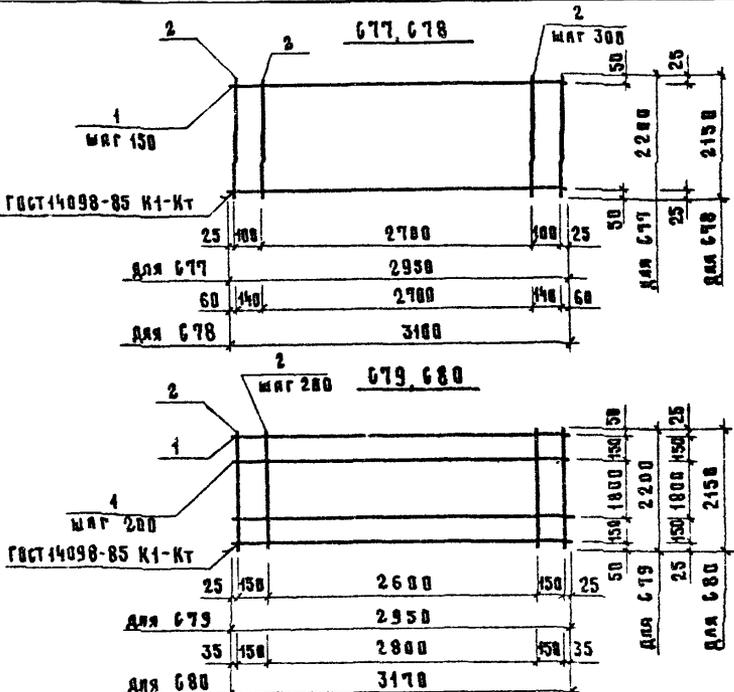
Арматура: для сеток C77 и C78 класса А-III по ГОСТ 5781-82, класса Вр-I по ГОСТ 6727-80, для сеток C79 и C80 класса Вр-I по ГОСТ 6727-80 или Врп-I по ТУ 14-4-1322-85
