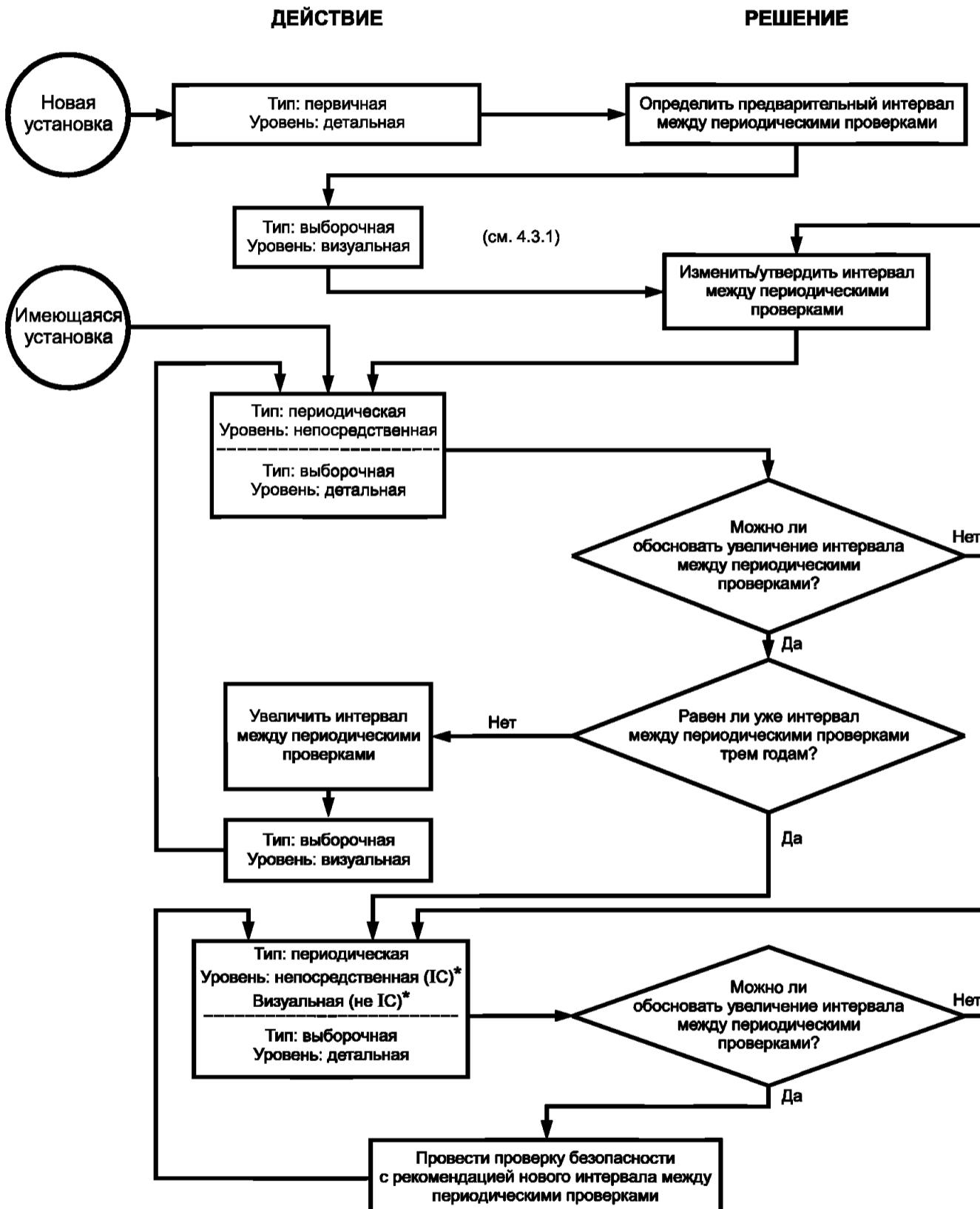
Рисунок А.1 — Типовой порядок проведения периодических проверок
