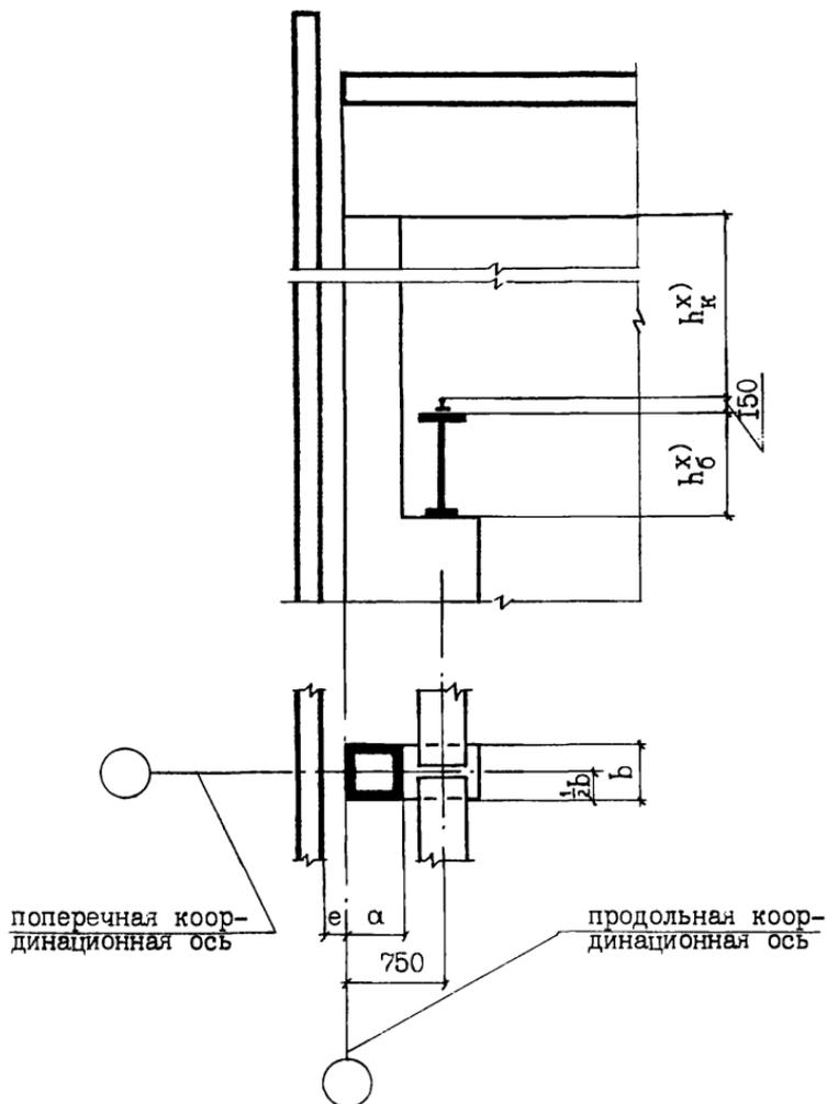
х) размеры  $h_k^x$  и  $h_0^x$  определяются по действующим сериям чертежей типовых конструкций в зависимости от принятых грузоподъемности и режима работы крана, шага колонн и материала подкрановых балок.
