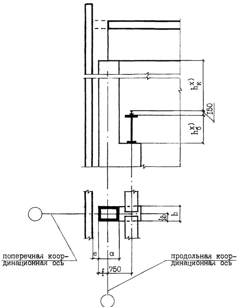
х) размеры  $h_k$  и  $h_6$  определяются по действующим сериям чертежей типовых конструкций в зависимости от принятых грузоподъемности и режима работы крана, шага колонн и материала подкрановых балок.
