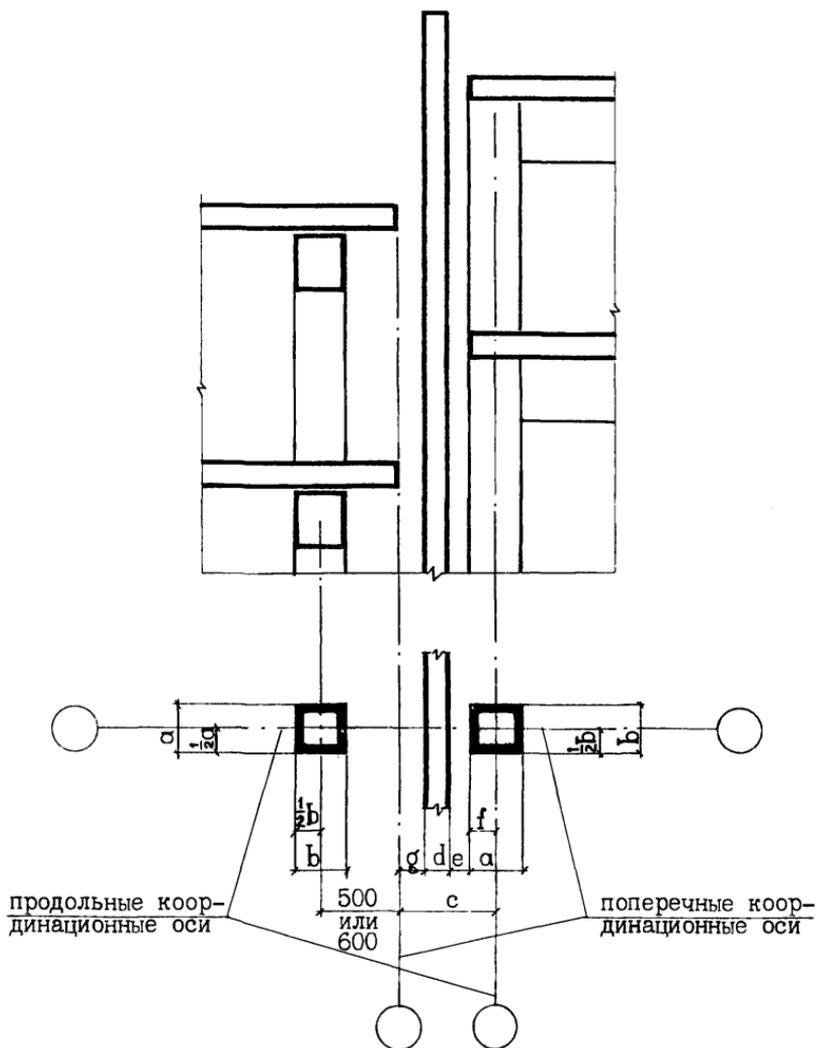
ПРИМЫКАНИЕ Пониженной секции торцом
