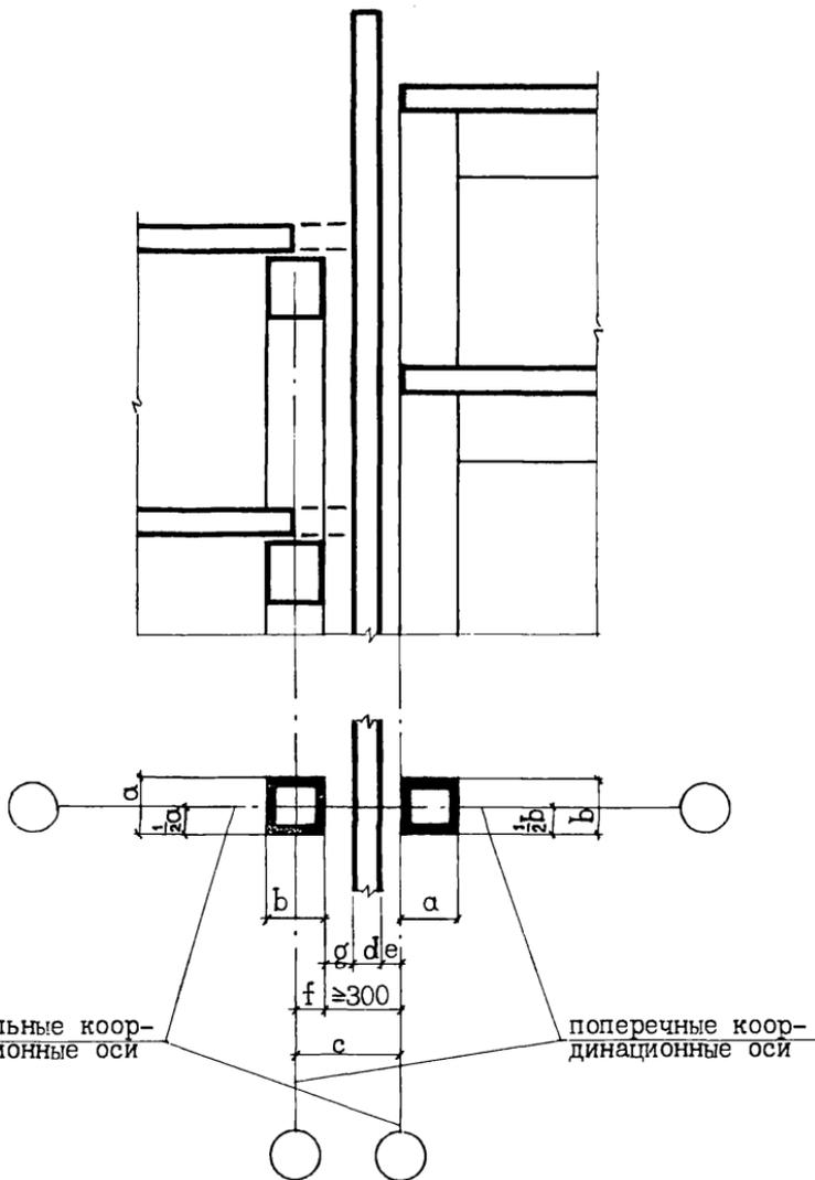
ПРИМЫКАНИЕ Пониженной секции торцом
