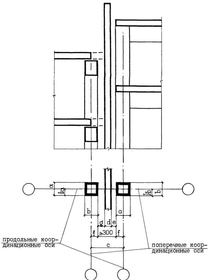
ПРИМЫКАНИЕ Пониженной секции торцом
