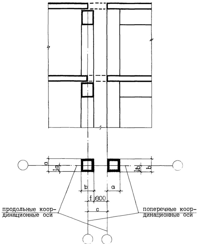
ПРИМЫКАНИЕ ОДНОТИПНЫХ СЕКЦИЙ С ВЗАИМНО ПЕРПЕНДИКУЛЯРНЫМ НАПРАВЛЕНИЕМ ПРОЛЕТОВ СО ВСТАВКОЙ  $c \geq 250$  мм
