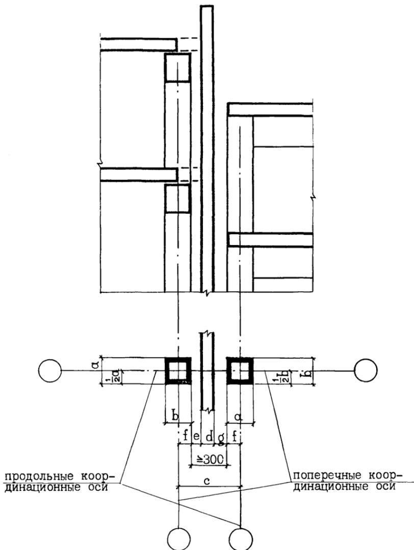
ПРИМЫКАНИЕ ПОВЫШЕННОЙ СЕКЦИИ ТОРЦОМ
