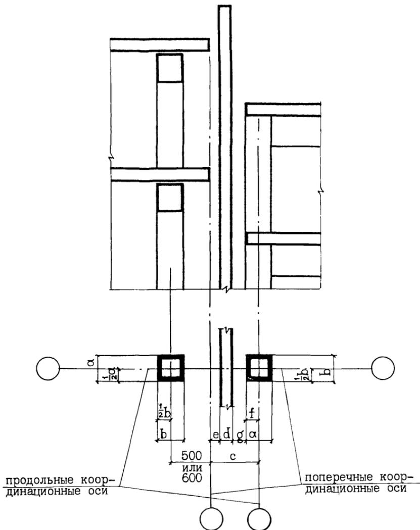
ПРИМЫКАНИЕ ПОВЫШЕННОЙ СЕКЦИИ ТОРЦОМ
