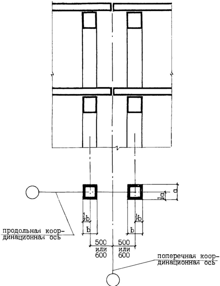
ПРИМЫКАНИЕ ОДНОТИПНЫХ СЕКЦИЙ С ВЗАИМНО ПЕРПЕНДИКУЛЯРНЫМ НАПРАВЛЕНИЕМ ПРОЛЕТОВ СО ВСТАВКОЙ  $c \geq 700$  мм
