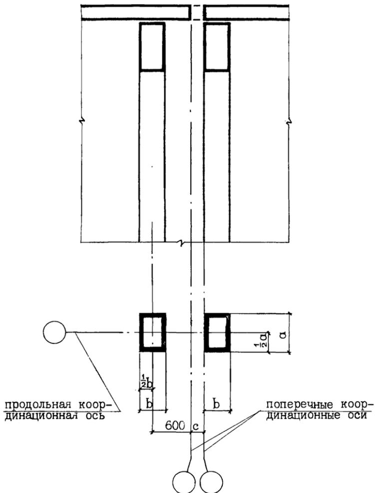
ПРИМЫКАНИЕ ОДНОТИПНЫХ СЕКЦИЙ С ВЗАИМНО ПЕРПЕНДИКУЛЯРНЫМ НАПРАВЛЕНИЕМ ПРОЛЕТОВ СО ВСТАВКОЙ  $c \geq 50$  мм
