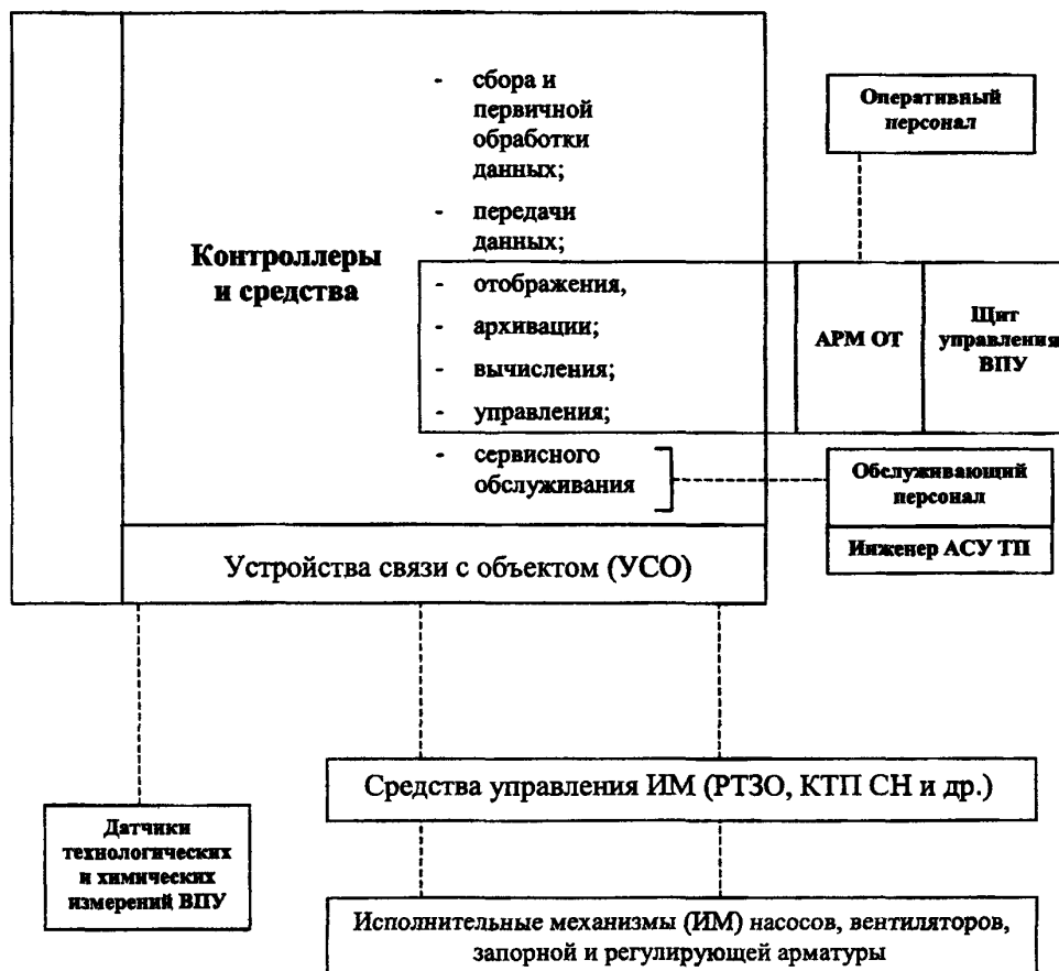
Рисунок 4 – Обобщенная структурная схема АСУ ТП ВПУ
