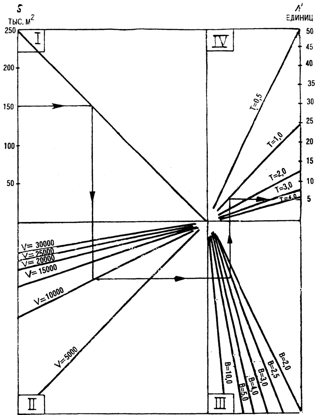
Рис. 6. Номограмма определения количества подметально-уборочных машин
