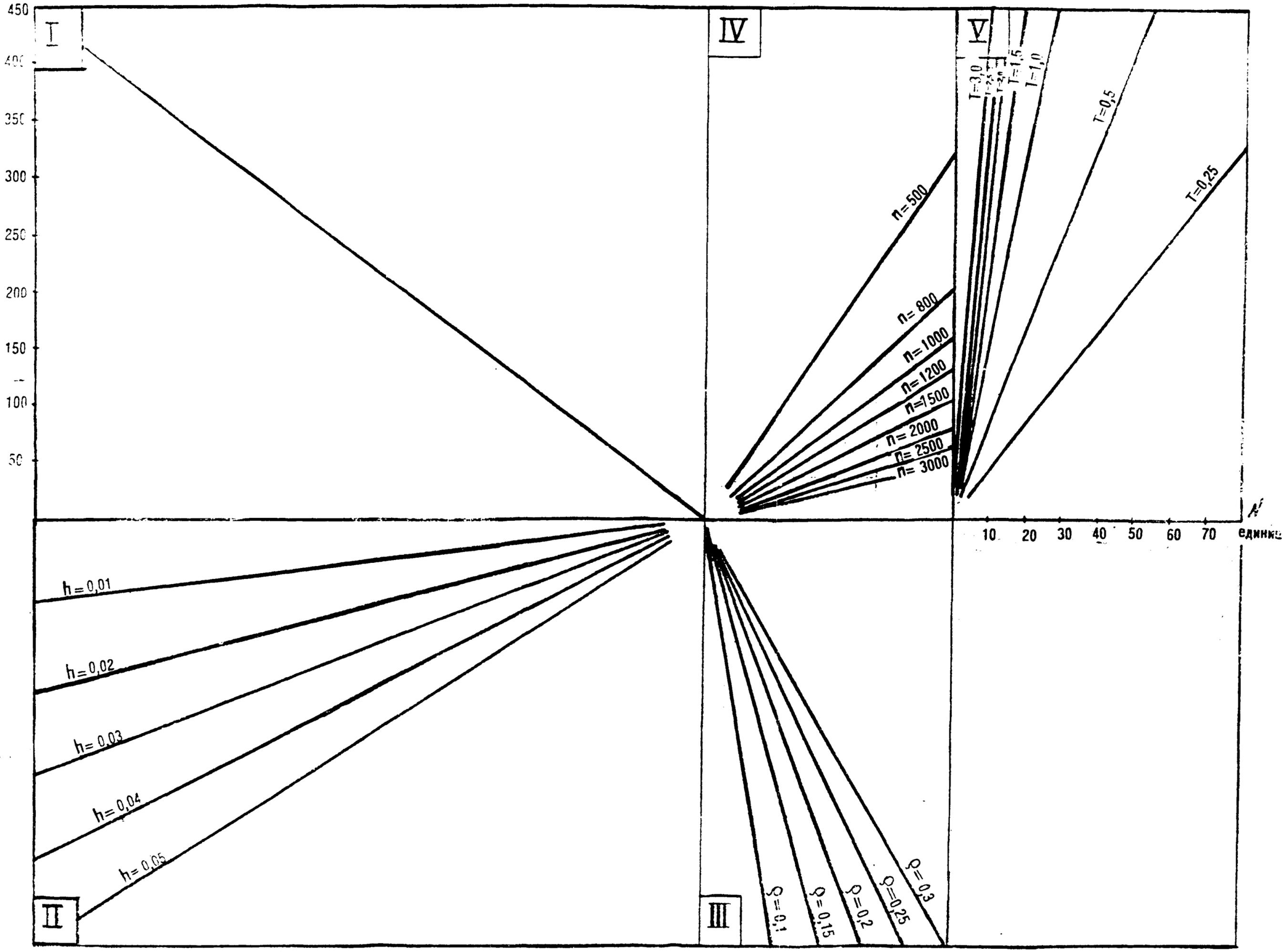
Рис. 2. Номограмма определения количества роторных снегоочистителей
