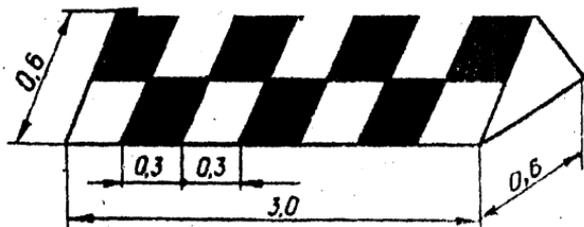
Рис. 3.24. Знак для обозначения опасных мест.
