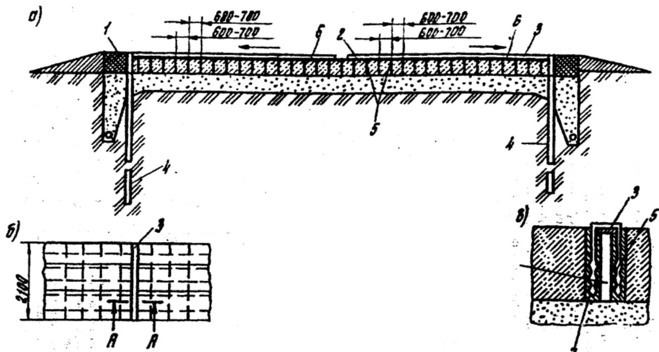
Рис. 5.3. Заземляющее устройство:
