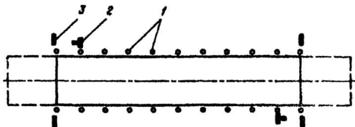
Рис. 3.12 Схема оборудования маркировочными знаками ГВПИ аэродромов класса Е:
