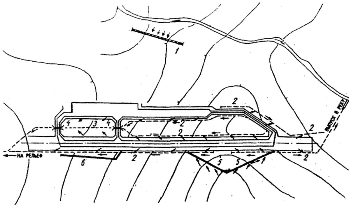
Рис. 5.5. Пример решения поверхностного водоотвода аэродрома:
