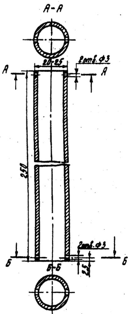
Рис. 6. Корпус (3). Материал – дюралевая трубка.
