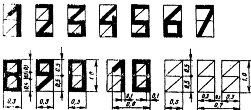
Рис. 3.9. Размеры и форма цифр на МС и перроне.
