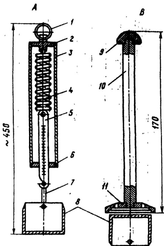
Рис.4. Пружинный плотномер.
