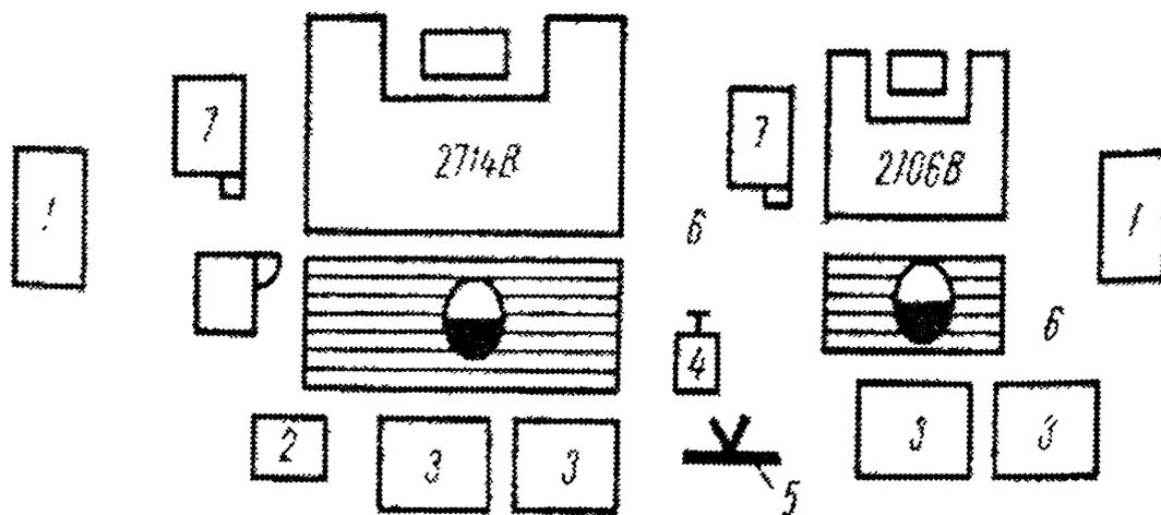
1 – шкаф инструментальный; 2 – столик приемный подвижный; 3 – стеллаж-подставка; 4 – стул подъемно-поворотный; 5 – планшет для чертежей; 6 – решетка под ноги рабочему; 7 – комплексный гидропривод.
