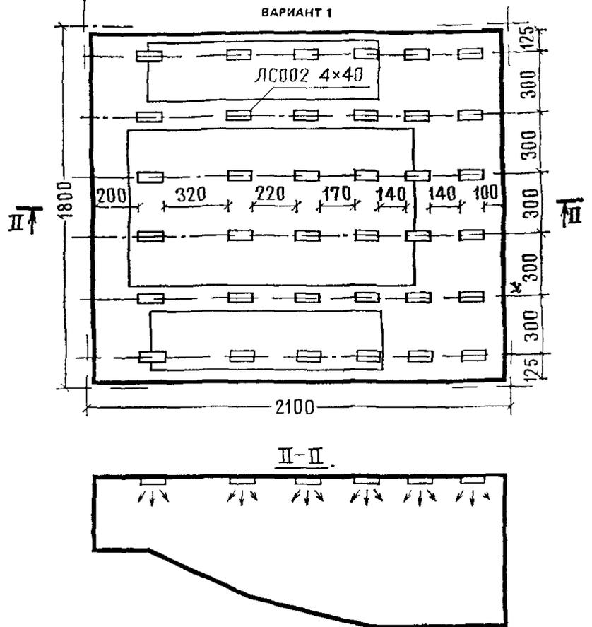
Примечание Привязка светильников по продольной оси может быть использована в любой аудитории такой же длины.
