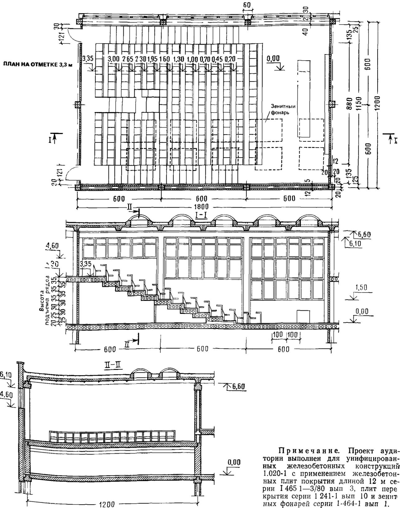
Примечание. Проект аудитории выполнен для унифицированных железобетонных конструкций 1.020-1 с применением железобетонных плит покрытия длиной 12 м серии 1.465 1—3/80 вып 3, плит перекрытия серии 1.241-1 вып 10 и зенитных фонарей серии 1.464-1 вып 1.
