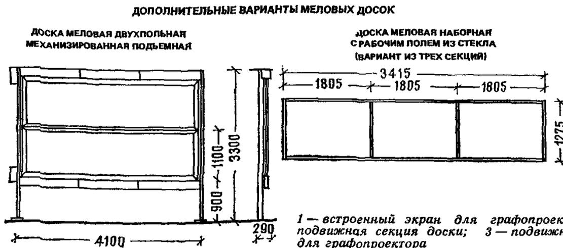
1 — встроенный экран для графопроектора; 2 — подвижная секция доски; 3 — подвижный экран для графопроектора
