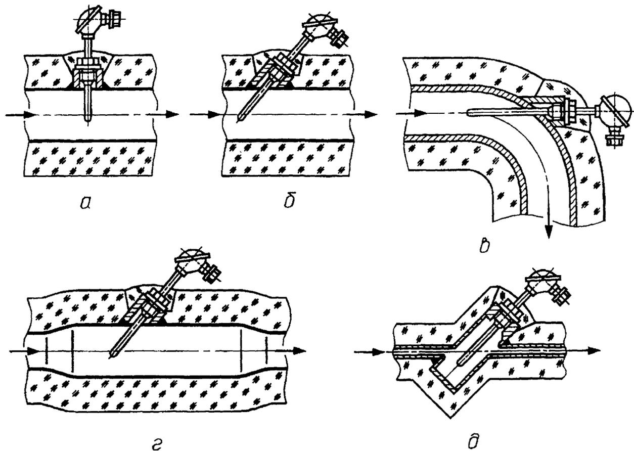
Расположение термометра: *a* — радиальное; *б* — наклонное; *в* — в изгибе колена; *г*, *д* — в расширителе
