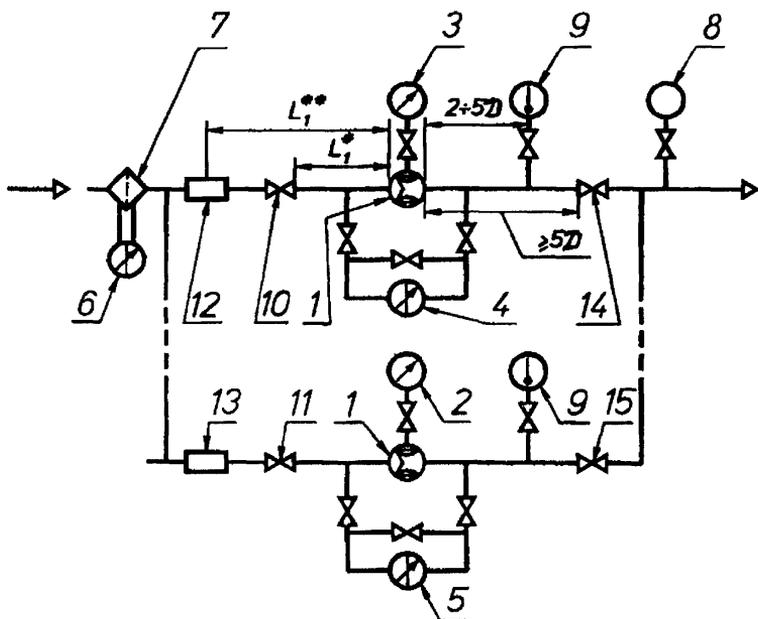
1 — счетчики; 2, 3 — манометры; 4, 5, 6 — дифманометры; 7 — фильтр очистки газа; 8 — хроматограф состава газа; 9 — термометры; 10, 11, 12, 13, 14, 15 — гидравлические сопротивления;  $L_1^{**}$ ,  $L_1^*$  — длины прямолинейных участков трубопроводов;  $L_1^{**}$ ,  $L_1^*$  — определяется в соответствии с 6.2.2.5
