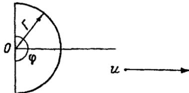
Точка "0" соответствует источнику заражения; угол  $\varphi = 180^\circ$ ; радиус полуокружности равен  $\Gamma$ ; биссектриса угла совпадает с осью следа облака и ориентирована по направлению ветра.
