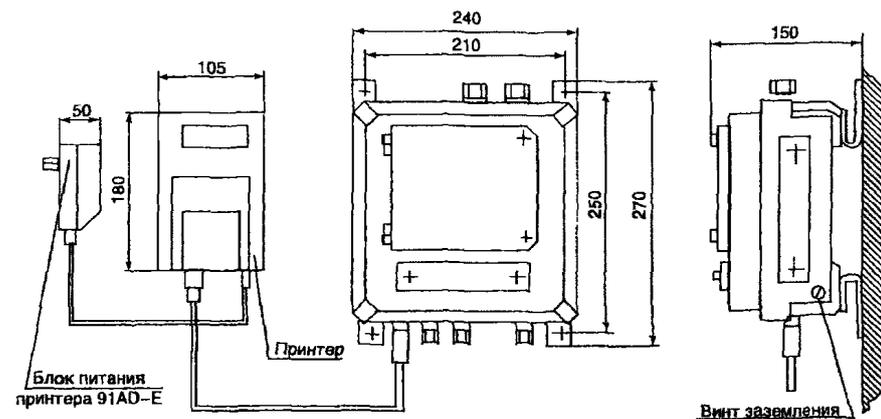
Схема установки UTC-1 с измерительным вторичным преобразователем ИПВ-5 и термодатчиком ТЧК
