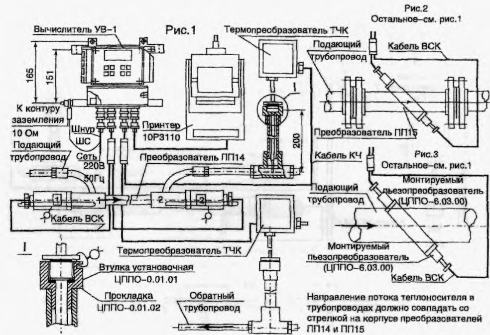
Рис. 1 – схема установки теплосчетчиков моделей UFEC 005-1C
