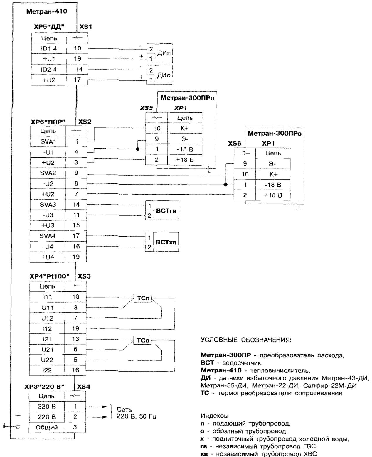
**Рис.1. Пример схемы соединений МЕТРАН-420-03**
