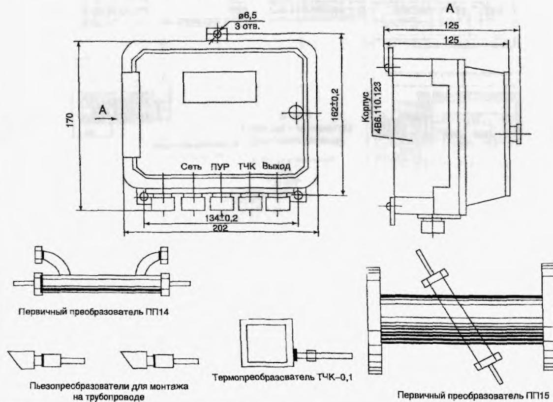
Схема установки теплосчетчиков модели UFEC 005-1
