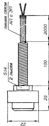
**НАЗНАЧЕНИЕ:** Метран-300ПР вихреакустический преобразователь объемного расхода с ультразвуковым детектированием вихрей в выходные импульсные сигналы предназначен для технологического и коммерческого учета расхода и объема воды (водопроводная, техническая, речная и т.п.) и водных растворов, кроме абразивных (вязкостью до  $2 \cdot 10^{-6}$  м<sup>2</sup>/с) в составе теплосчетчиков Метран-400, СТ УИМ и др., счетчиков-расходомеров в заполненных трубопроводах систем водо- и теплоснабжения.
