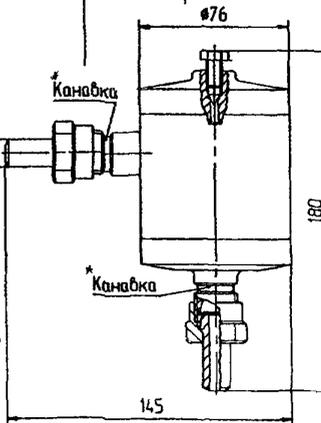
\* Канавка только у сосудов СУ-40. Присоединение импульсных линий с помощью сварки по Ø 14.
