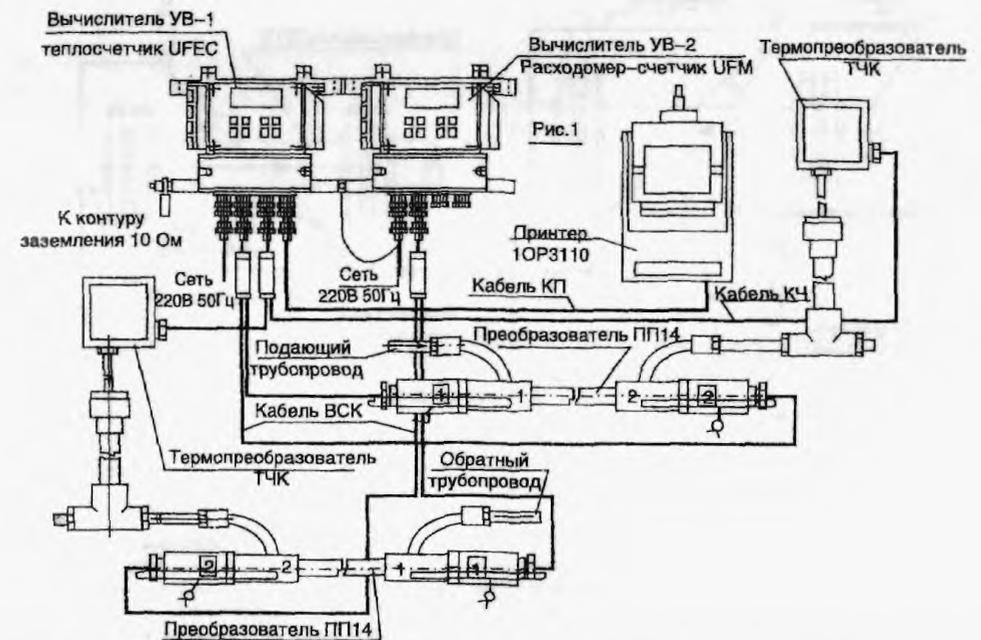
Схема установки теплосчетчиков UFEC 005-2М (2С)
