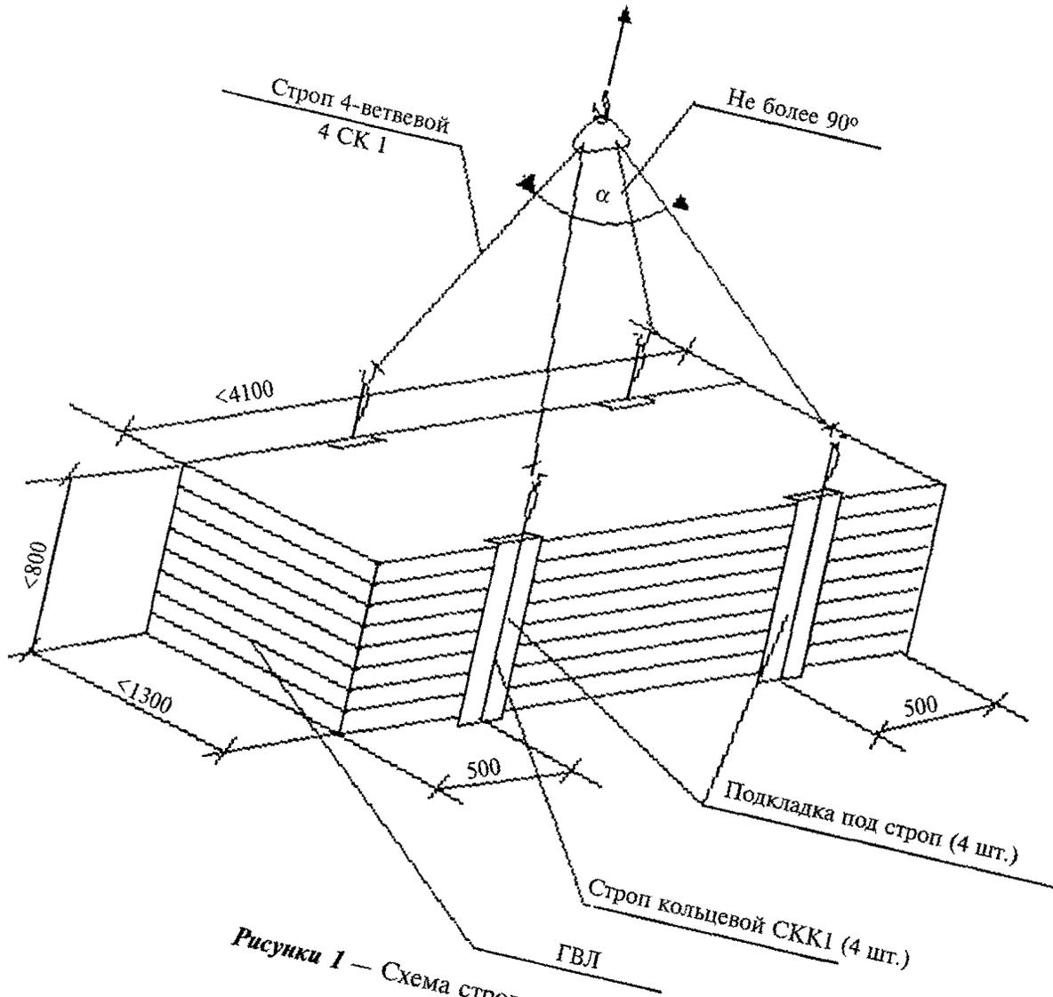
Рисунки 1 — Схема строповки пакета ГВЛ
