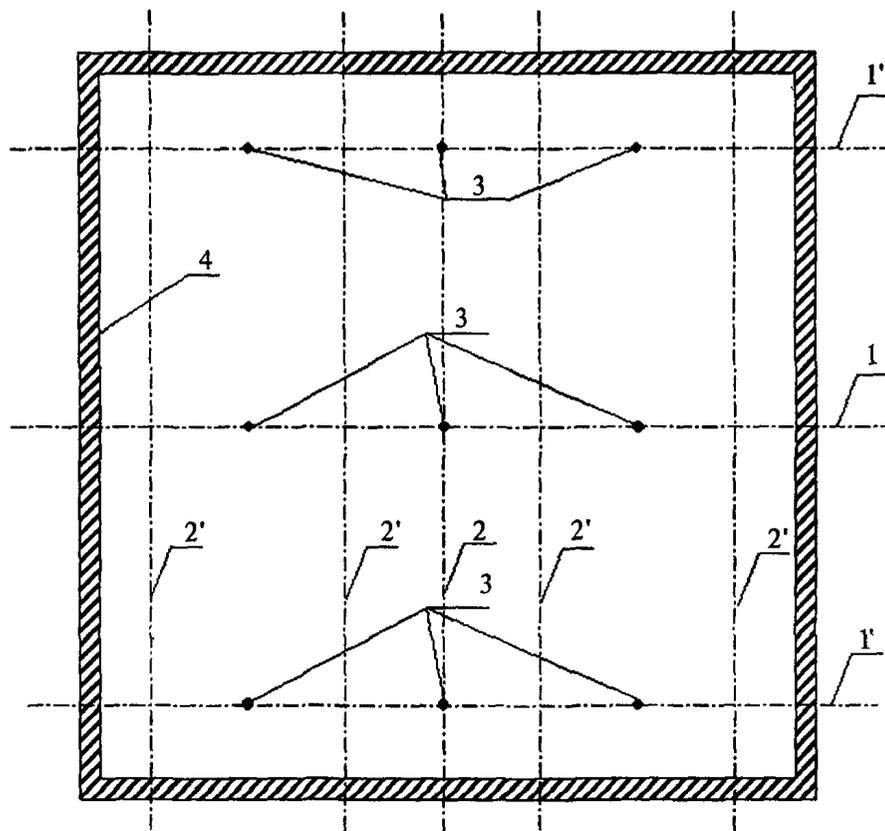
**1, 2** — разметка центральных взаимно перпендикулярных осей; **1'** — разметка положения основных профилей; **2'** — разметка положения несущих профилей; **3** — разметка положения подвесов потолка; **4** — разметка на примыкающих стенах помещения положения профилей ПНП (для конструкции П 213)
