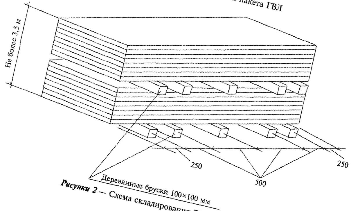
Рисунки 2 — Схема складирования ГВЛ на объекте
