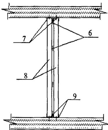
1 — направляющие пола и потолка; 2 — стойки несущего каркаса; 3 — первый слой ГВЛ с двух сторон; 4 — второй слой ГВЛ с двух сторон; 5 — разделительная лента; 6 — уплотнительная лента; 7 — профиль направляющий потолка; 8 — профиль стоечный; 9 — профиль направляющий пола
