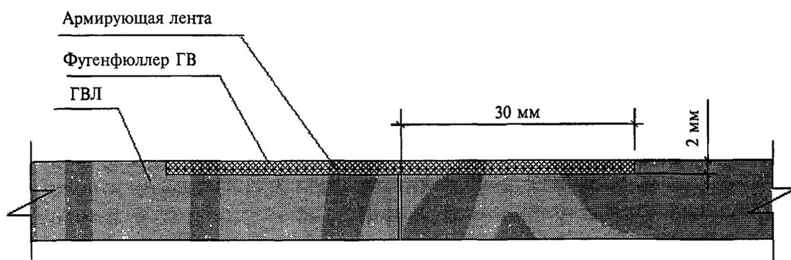
**Рисунок 5** — Схема устройства горизонтального шва
