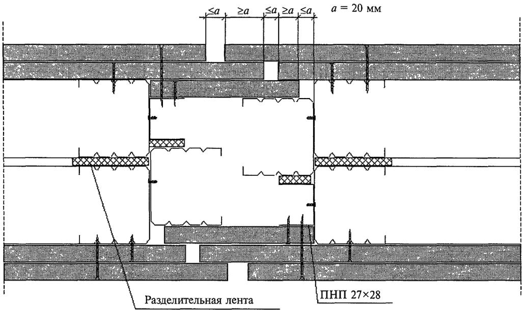
**Рисунок 19** — Схема устройства деформационного шва в перегородке С 365
