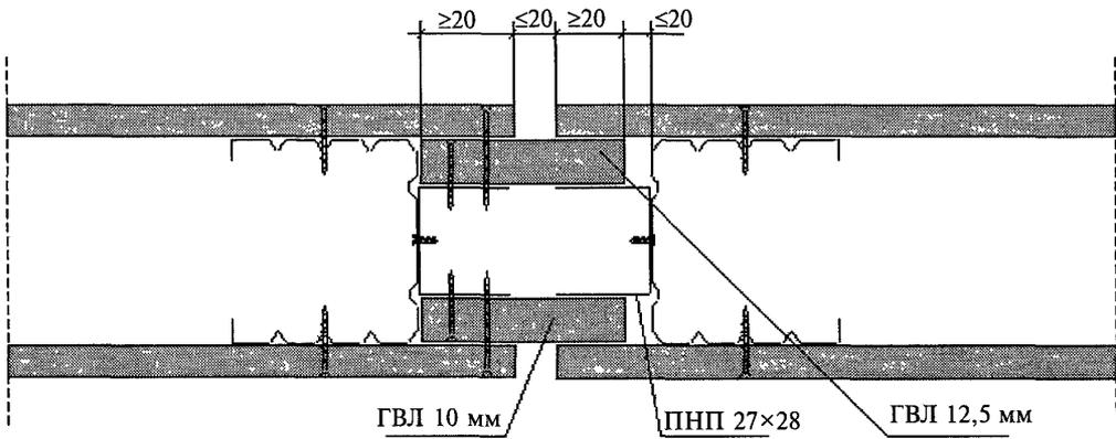
**Рисунок 10** — Схема устройства деформационного шва в перегородке С 361
