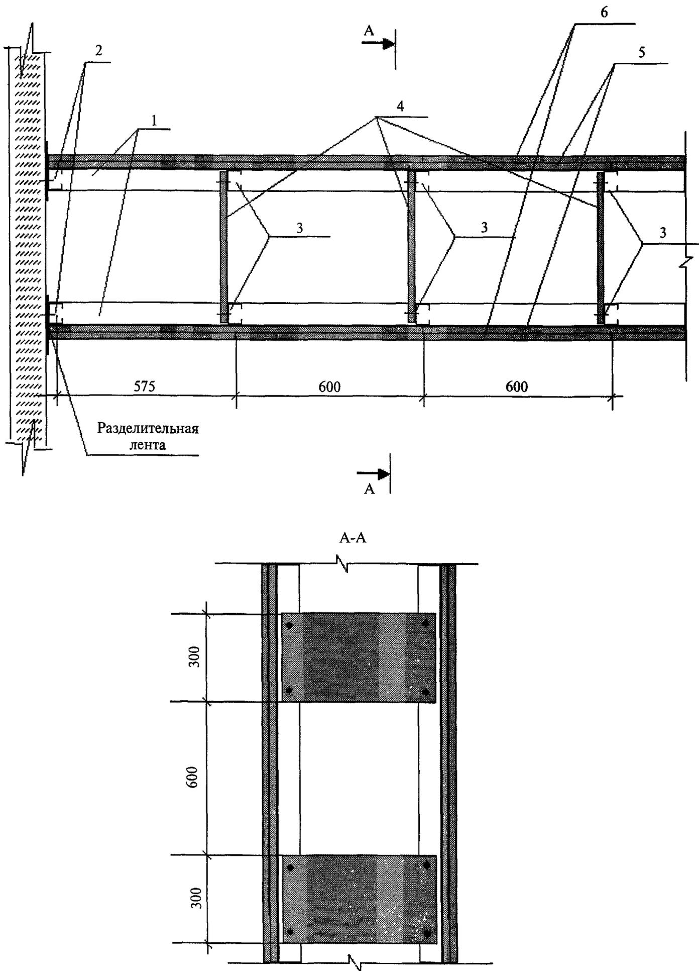
1 — направляющие профили пола; 2 — стоечные профили, примыкающие к основным конструкциям; 3 — стоечные профили; 4 — вставка из ГВЛВ; 5 — первый слой ГВЛВ; 6 — второй слой ГВЛВ
