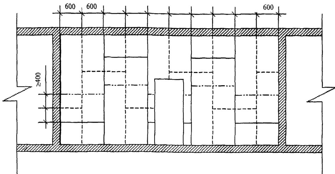
**Рисунок 14** — Схема расположения ГВЛ перегородки С 363 (сплошные линии — листы первого слоя, пунктирные — листы второго слоя, штрихпунктирные — листы третьего слоя; второй слой смещен относительно первого на один шаг стойки)
