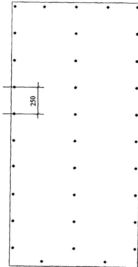
**Рисунок 9** — Схема расположения самонарезающих винтов при однослойной облицовке
