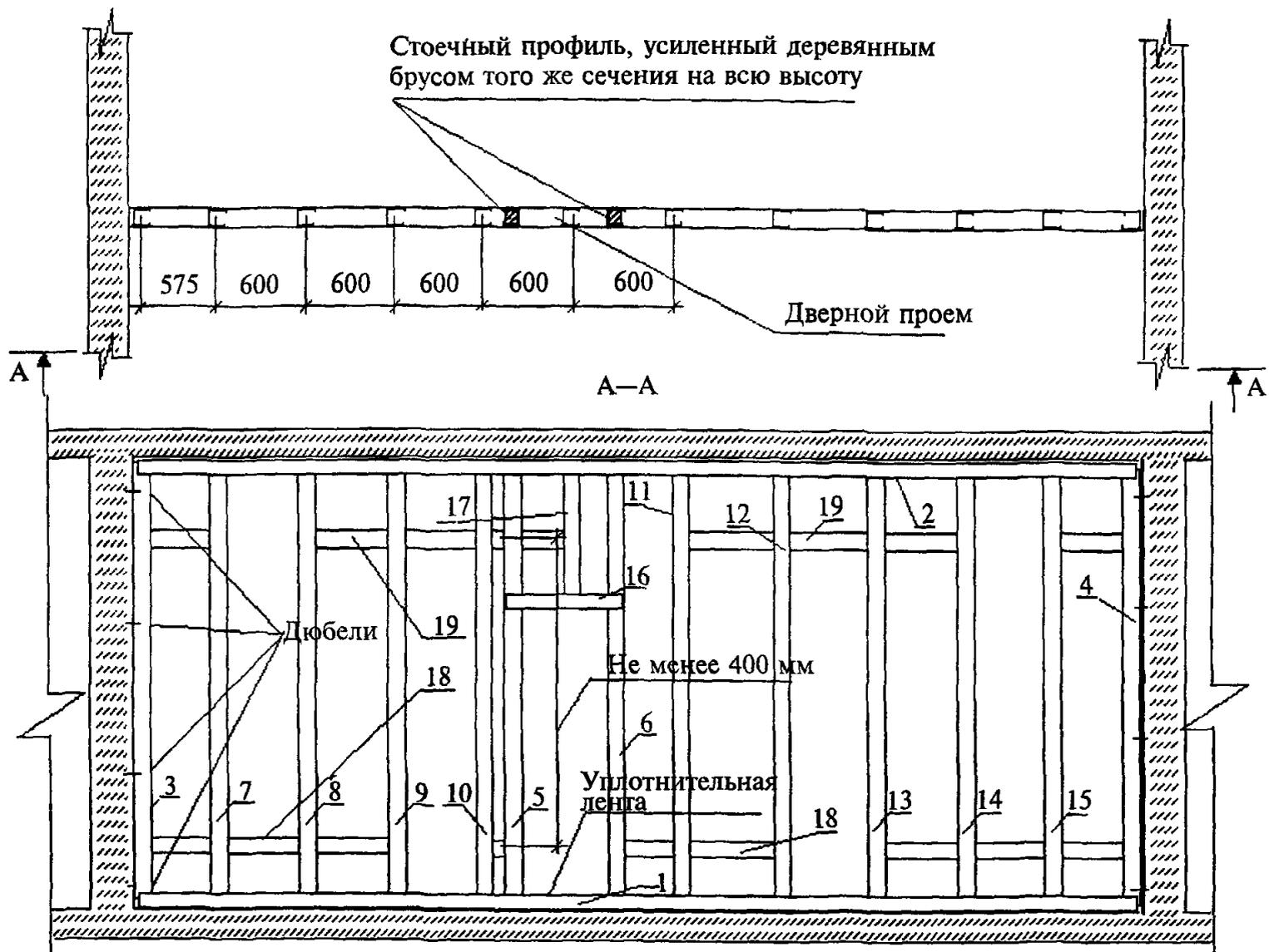
1 — ПН на полу; 2 — ПН на потолке; 3, 4 — ПС, примыкающие к конструкциям здания; 5, 6 — ПС, ограничивающие дверной проем; 7—15 — монтаж профиля каркаса с сохранением проектного шага; 16 — монтаж перемычки над дверным проемом; 17 — монтаж ПС с сохранением шага над дверным проемом; 18, 19 — монтаж горизонтальных вставок из ПН под горизонтальные швы ГКЛ
