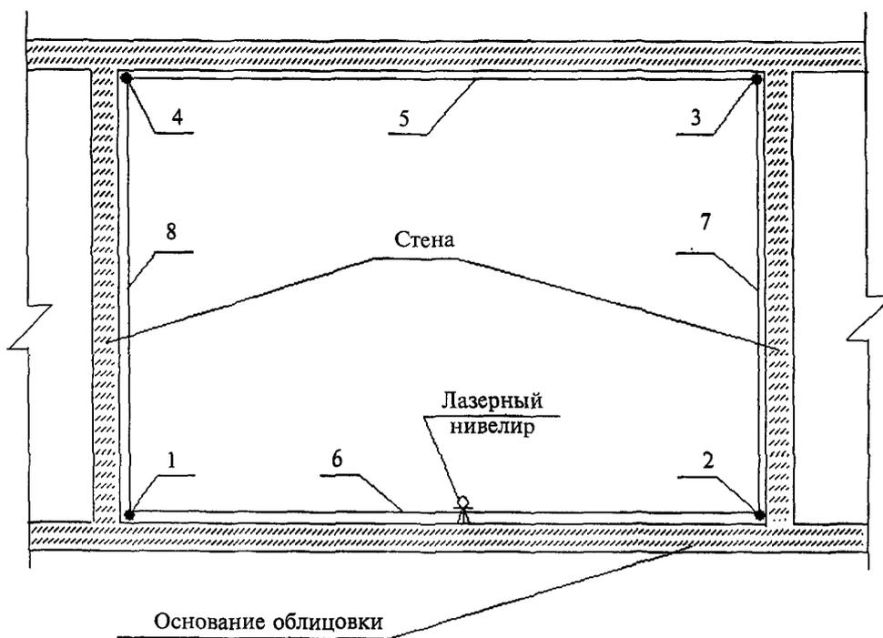
1, 2, 3, 4 — нанесение точек на основные конструкции помещения; 5, 6, 7, 8 — разметка оси шнуротбойным устройством
