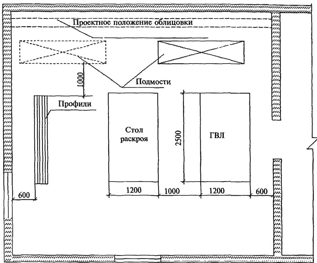
Рисунок 21 — Схема организации рабочего места при облицовке стен
