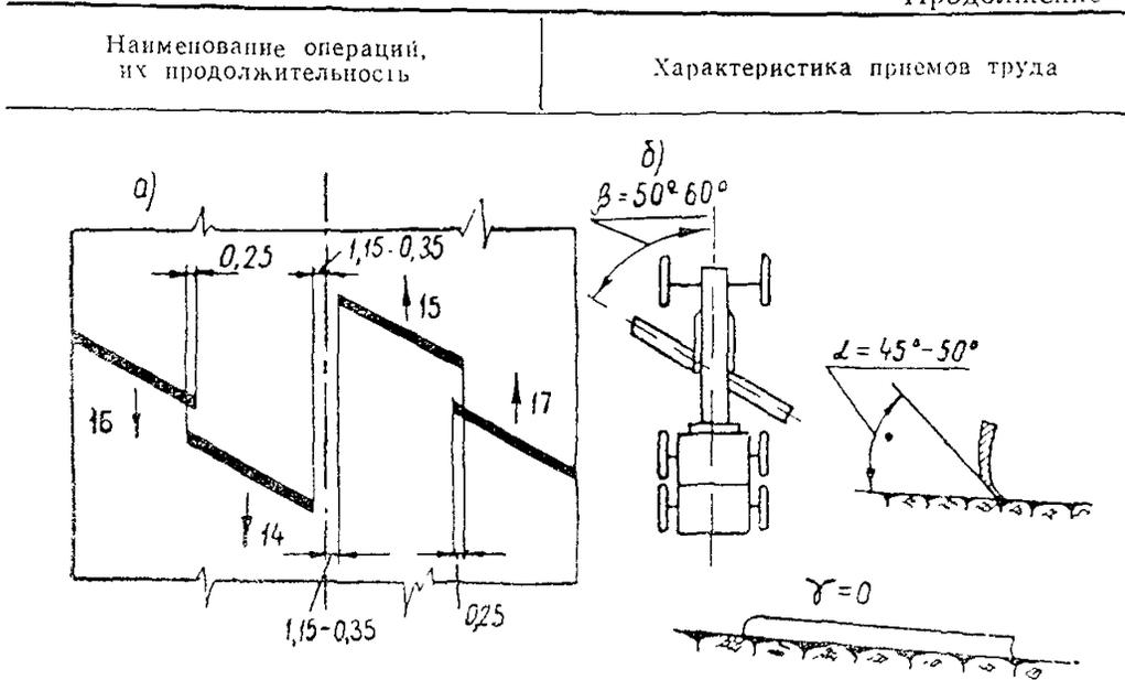
Рис. 4. Схема проходов 14—17 автогрейдера при третьем цикле:
