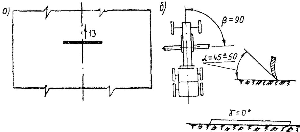
Рис. 3. Схема прохода № 13 автогрейдера при третьем цикле:
