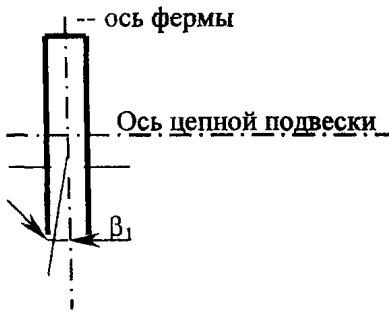
Рис 2.6. Схема для определения угла скольжения ветра относительно ригеля.
