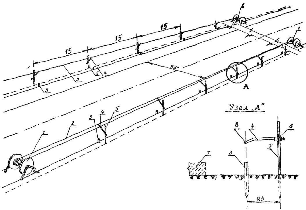
Рис. 1. Схематичный план участка установки копирных струн:
