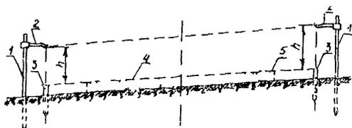
Рис. 2. Расположение струн при односкатном профиле.
