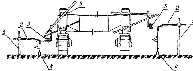
Рис. 5. Установка копирных струн в разных уровнях:
