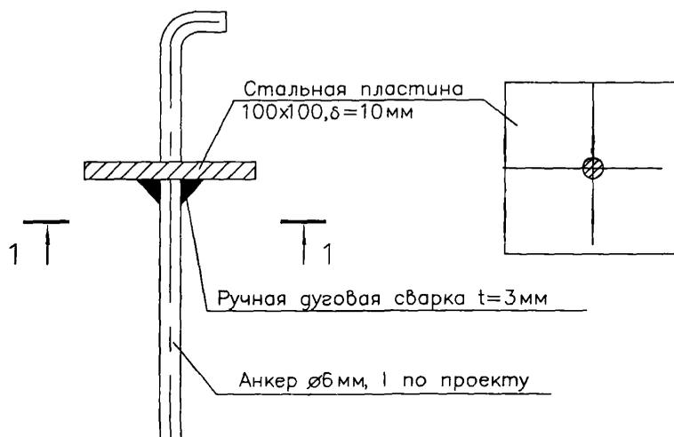
Рисунок 4 – Конструктивное решение армирования кирпичной кладки облицовки угловой части фасада здания
