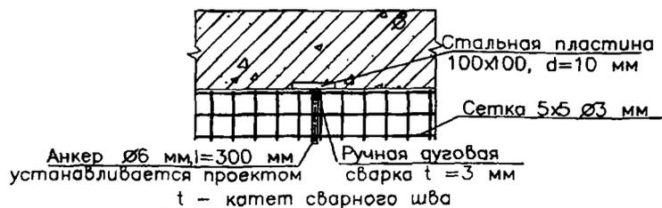
Рисунок 2 – Схема расстановки закладных деталей, устройства металлических анкеров
