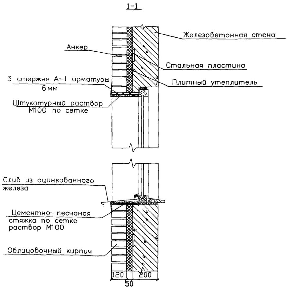
Рисунок 5 – Конструктивное решение облицовки оконных проемов
