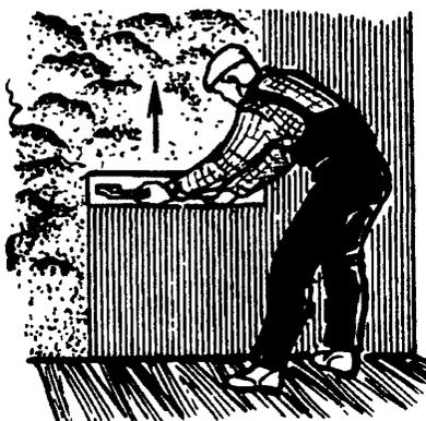
Рисунок 6 – Разравнивание раствора полутерком
