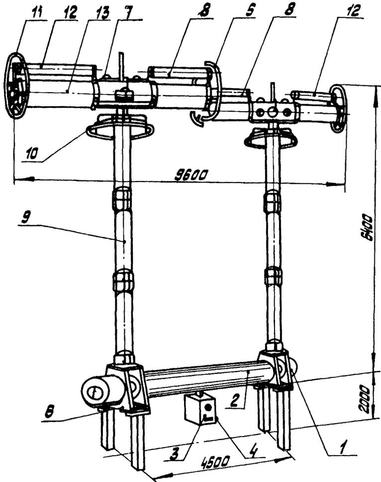
1-подвод сжатого воздуха; 2-резервуар; 3-шкаф управления;
