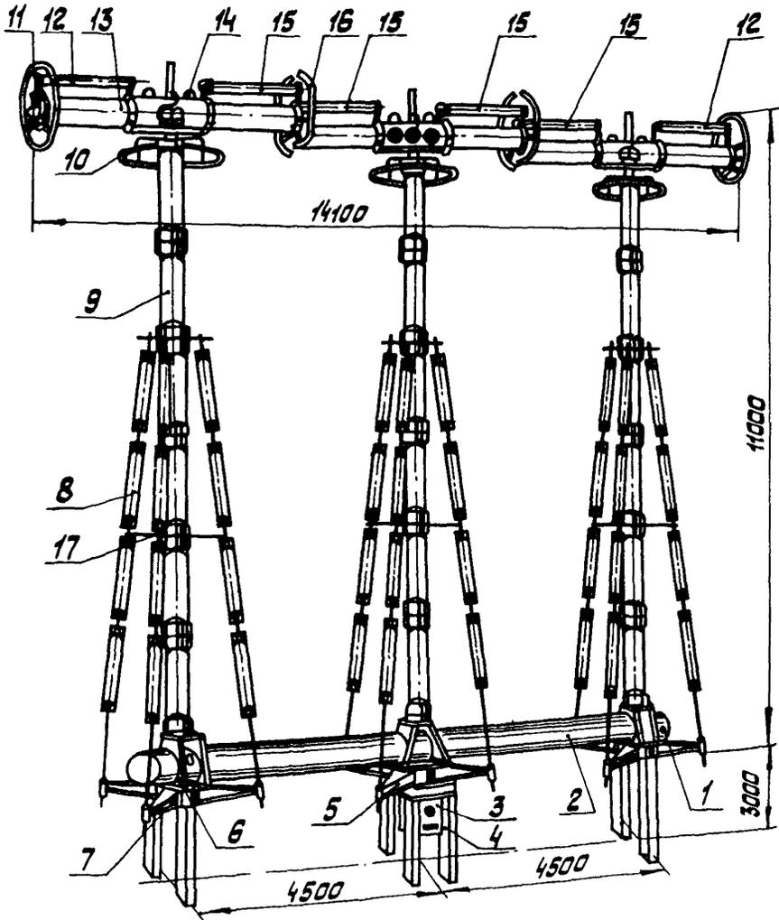
1 - подвод сжатого воздуха; 2 - резервуар; 3 - шкаф управления; 4 - болт заземления М10; 5,7 - рама; 6 - болт заземления М16; 8 - растяжки; 9 - колонка опорных изоляторов; 10, 11, 16 - экраны; 12 - конденсатор (1400пФ); 13 - дугогасительное устройство; 14 - подъемное ушко; 15 - конденсатор (1100 пФ); 17 - пояс жесткости.
