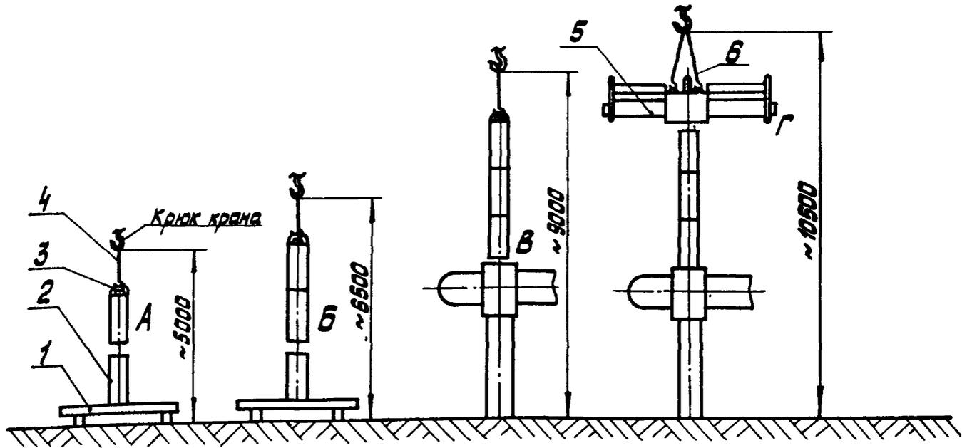
А, Б, В, Г - последовательность сборки; 1- настил из досок; 2- изолятор опорной колонки; 3- приспособление для подъема изоляторов; 4- стропы ИСК-1,6/0-1,6/КИ-1,6/1400; 5- дугогасительное устройство; 6- стропы 2СК-3,2/Рт1-3,2/КИ-2,5/1400.
