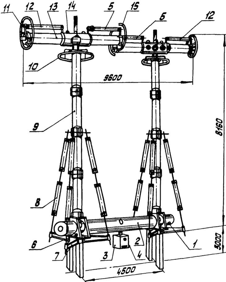
1 - подвод сжатого воздуха; 2 - резервуар; 3 - шкаф управления; 4 - болт заземления М16; 5 - конденсатор (1400 пФ); 6 - болт заземления М16; 7 - рама; 8 - растяжка; 9 - колонна опорных изоляторов; 10, 11, 15 - экраны; 12 - конденсатор (1600 пФ); 13 - дугогасительное устройство; 14 - подъемное ушко.
