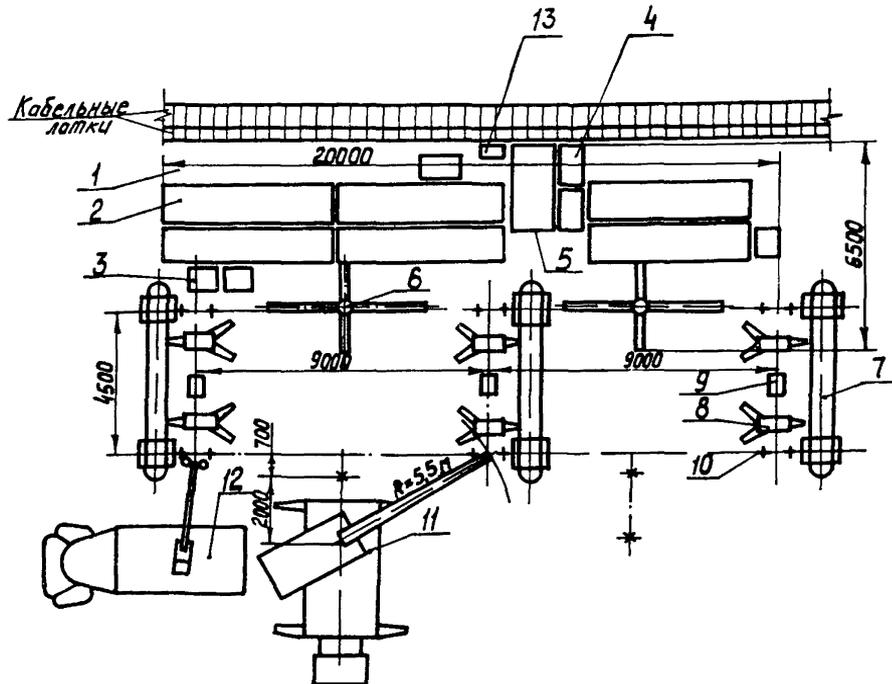
1- площадка для разгрузки и укрупнительной сборки; 2- дугогасительные устройства; 3- конденсаторы в упаковке; 4- опорные изоляторы в упаковке; 5- изоляторы растяжек в упаковке; 6- инвентарный столик; 7- резервуар; 8- рама; 9- шкаф управления; 10- опорные конструкции; 11- автокран СМК-10; 12- гидравлический подъемник АПП-22; 13- шкаф распределительный.
