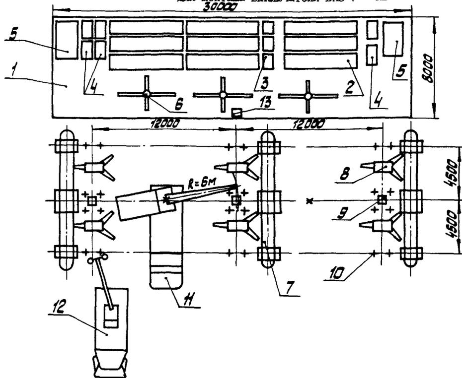
1 - площадка для разгрузки и укрупнительной сборки; 2 - дугогасительное устройство; 3 - конденсаторы; 4 - опорные изоляторы; 5 - изоляторы растяжек; 6 - инвентарный столик; 7 - резервуар; 8 - рама; 9 - шкаф управления; 10 - опорные конструкции; 11 - автокран К-162; 12 - гидравлический подъемник АП-22.
