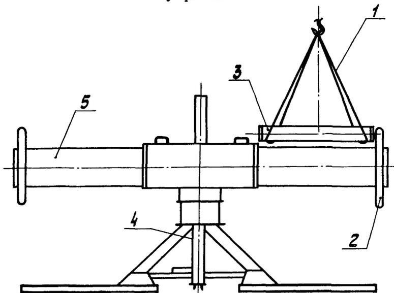
1- канат капроновый,  $\varnothing$  16мм; 2- экран гасительного устройства; 3- конденсатор; 4- стол монтажный; 5- дугогасительное устройство.
