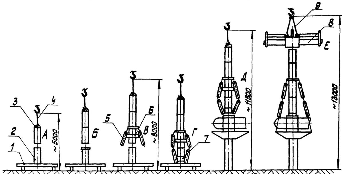
А, Б, В, Г, Д, Е - последовательность сборки; 1- настил из досок; 2- изолятор опорной колонки; 3- приспособление для подъема изоляторов; 4- строп ИСК-2,5/С-2,5/К-2,5/И40С; 5- изолятор растяжки; 6- приспособление для предохранения изолятора; 7- жгут из ткани; 8- дугогасительное устройство; 9- строп 2СК-3,2/Рт1-3,2/К1-2,5/И40С.
