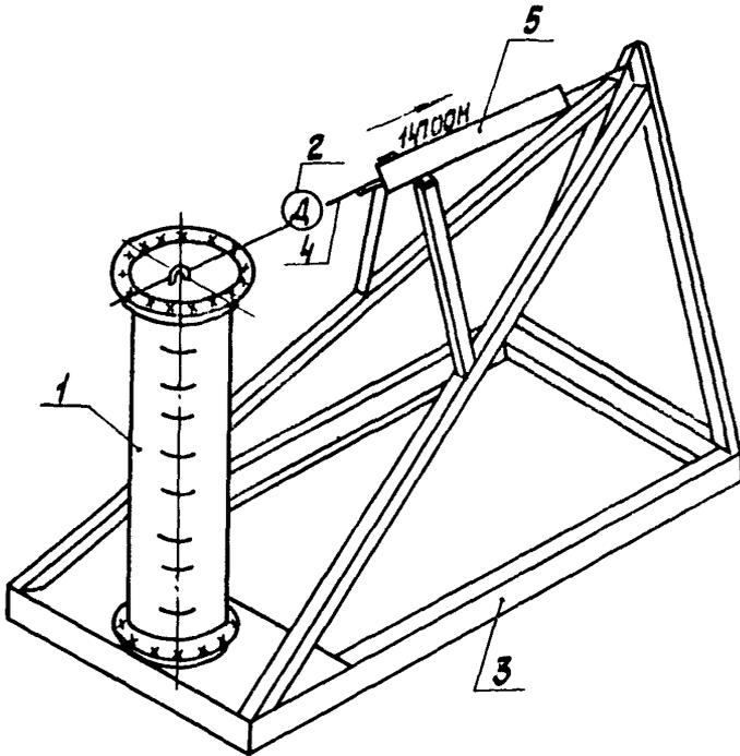
1 - опорный изолятор; 2 - динамометр; 3 - стенд; 4 - трос;
