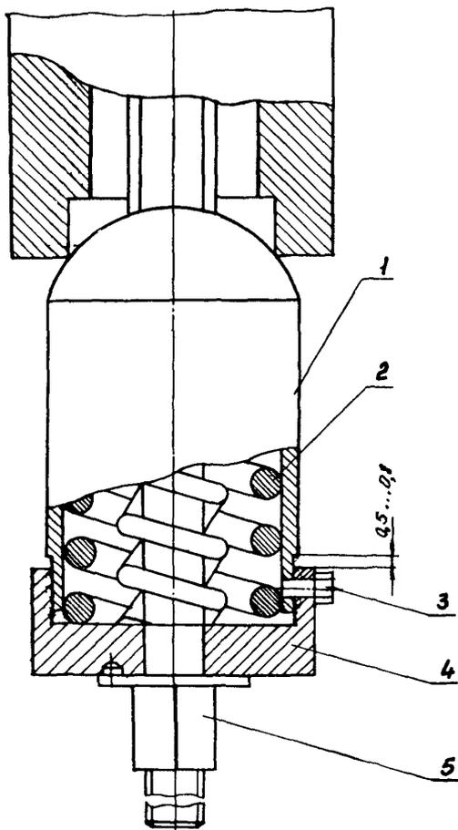
1 - стакан; 2 - пружина; 3 - болт; 4 - нажимной фланец; 5 - гайка.
