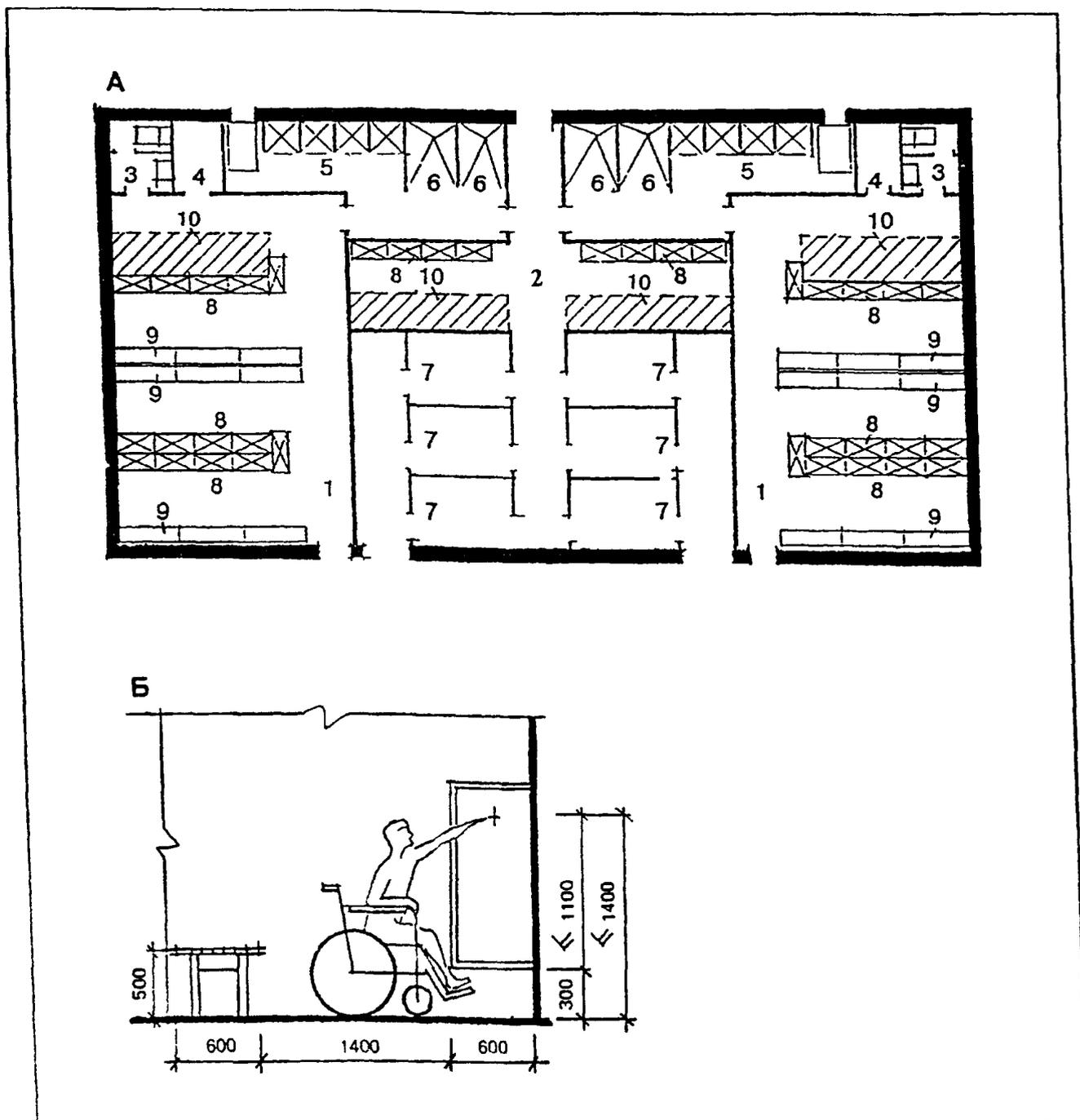
Блок раздевальных и душевых при ванне размером 16,6x8 м
