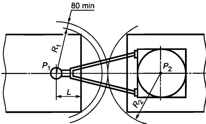
$R_1$  — радиус габарита задней части тягача (прицепа или полуприцепа для многозвездного автопоезда);  $R_2$  — радиус габарита передней части прицепа;  $P_1$  — центр тягово-сцепного устройства;  $P_2$  — центр поворотного устройства прицепа;  $L$  — расстояние до центра тягово-сцепного устройства (для прицепов с центральной осью (осями) — не более 420 мм)
