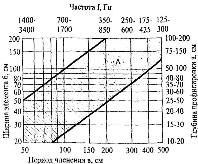
**Рис. 4.5.6.** Размеры членений диффузно отражающей поверхности:
