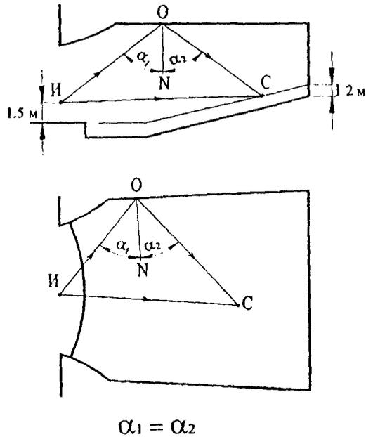
Рис. 4.5.3. Графическое построение отражения звуковых лучей:
