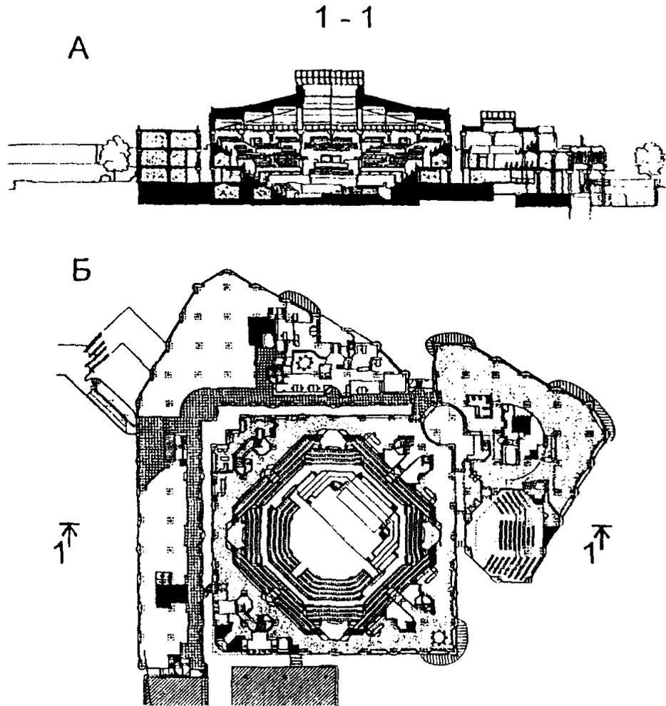
А – Разрез 1 – 1, Б - план второго этажа.
