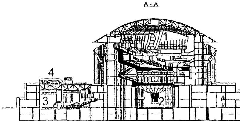
Разрез по сцене и амфитеатру большого и театрально-концертного залов и поперечный разрез зала камерной музыки:
