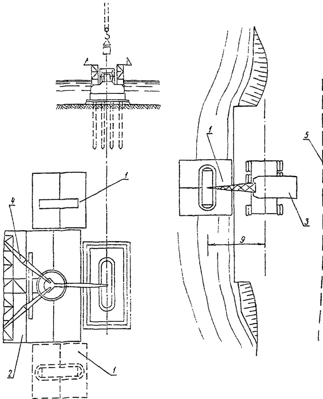
Рис. 5. Схема организации работ по сооружению опоры на воде:
