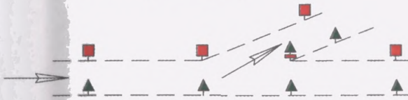
Рисунок Б.10 - Разделение неравнозначных каналов (фарватеров). Основной канал (фарватер) справа.
