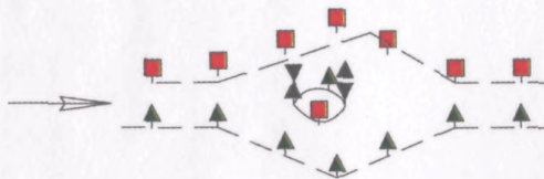
Рисунок Б.8 - Канал (фарватер) разделяется опасностью на два, затем снова соединяется
