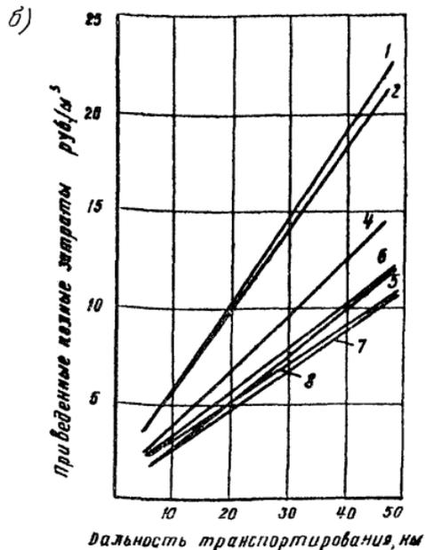
Рис.5. Изменение приведенных эксплуатационных (а) и полных (б) затрат на транспортирование бетонной смеси в зависимости от дальности и типа транспортных средств (III категория дороги): 1-автобетоновосмеситель СБ-89; 2-то же СБ-58; 3-то же СБ-83; 4-самосвал ЗИЛ-ММЗ-555; 5-автобетоновоз емкостью 3 м<sup>3</sup>; 6-самосвал МАЗ-508Б; 7-автобетоновоз емкостью 5 м<sup>3</sup>; 8-самосвал
