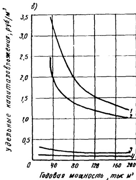
Рис.4. Изменение удельных капиталовложений в оборудование (а), в строительство (б) и в передислокацию (в) в зависимости от мощности и типа ЦБЗ:
