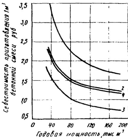
Рис.3. Зависимость себестоимости приготовления  $1\text{ м}^3$  бетонной смеси от мощности и типа ЦБЗ:
